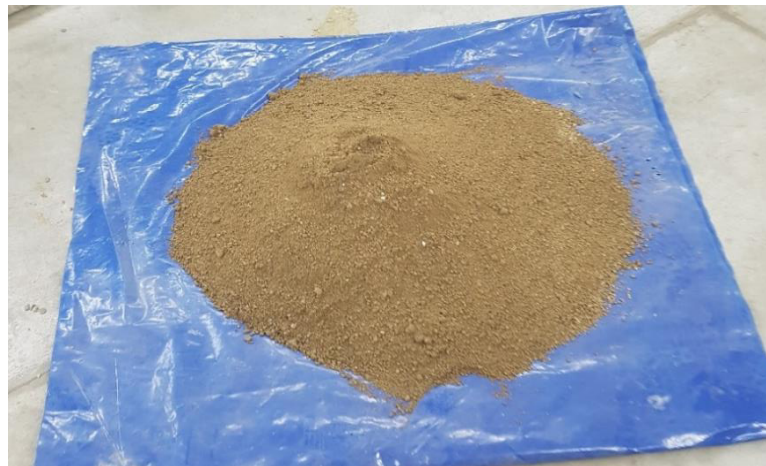
Figura N° 8: Agregado Fino preparado para el Ensayo
