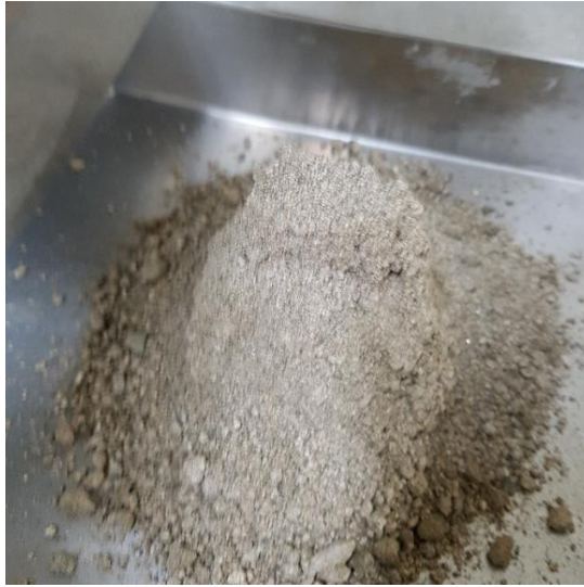
Figura N° 34: Derrumbe de la Arena
