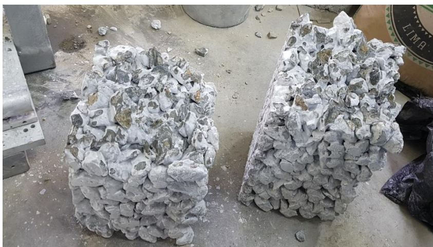
Figura N° 68: Rotura de Viga
