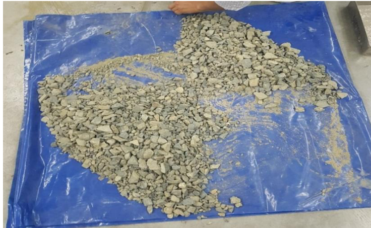
Figura N° 7: Agregado Grueso de los Extremos Opuestos
