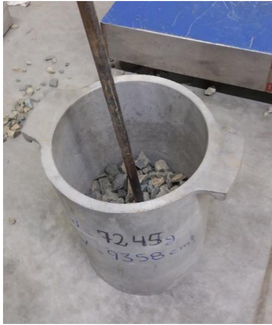
Figura N° 37: Compactación de la primera capa de Agregado Grueso
