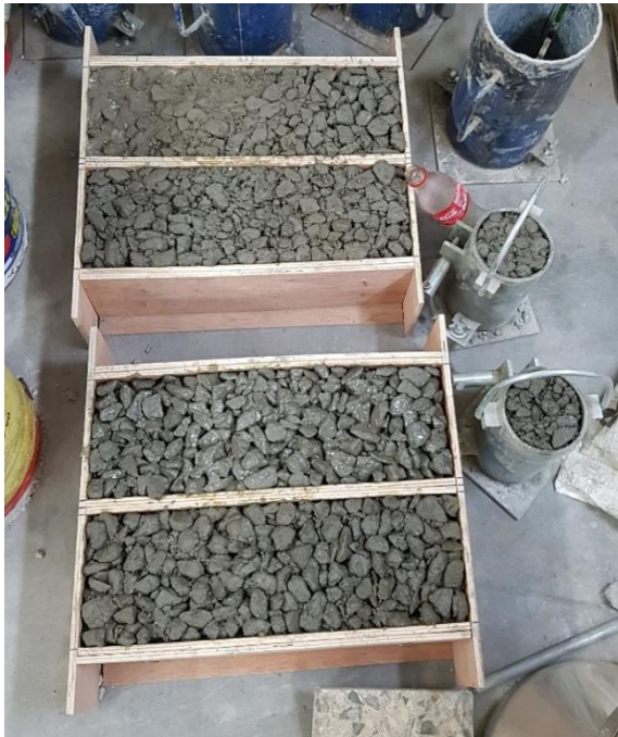
Figura N° 57: Moldes llenados con Concreto Permeable
