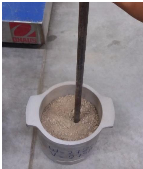
Figura N° 39: Compactación de la segunda capa de Agregado Fino
