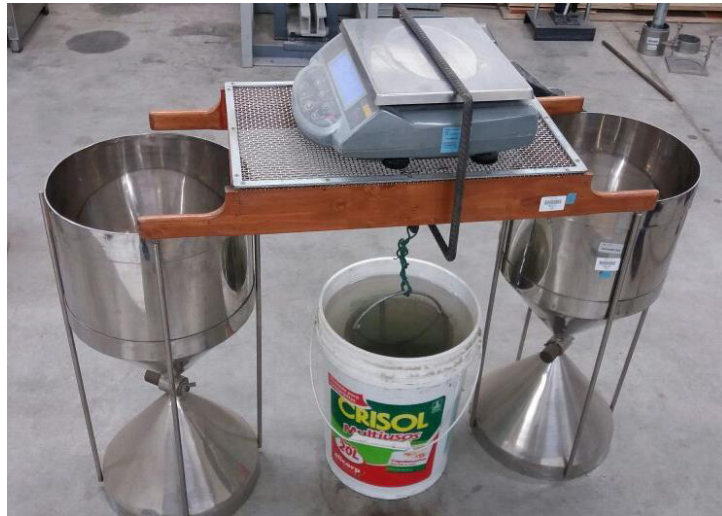
Figura Nº 26: Balanza apoyada en los soportes para calcular el Peso del Agregado Grueso Saturado Superficialmente Seco Sumergido
