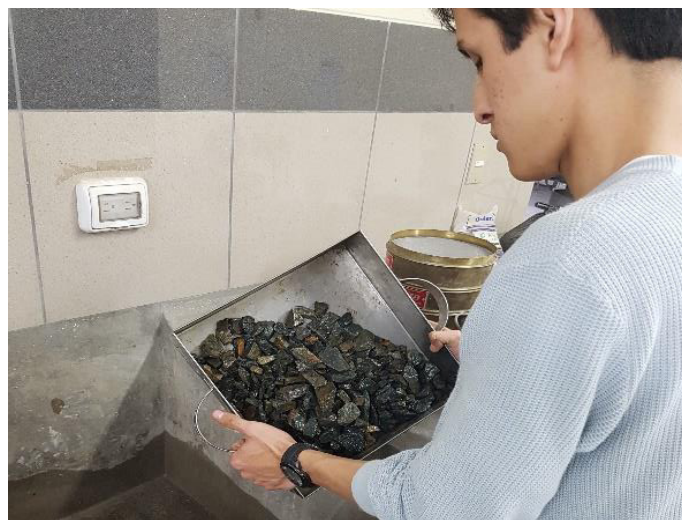
Figura N° 12: Lavado del Agregado Grueso
