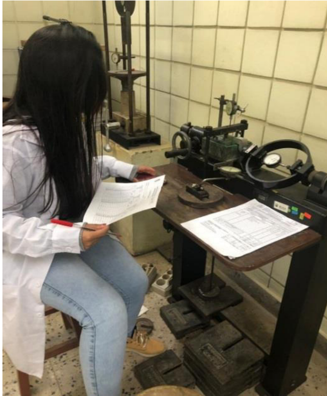
Figura 22. Ensayo de Corte Directo
