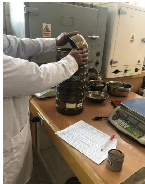
Figura 19. Ensayo de Granulometría por Tamizado
