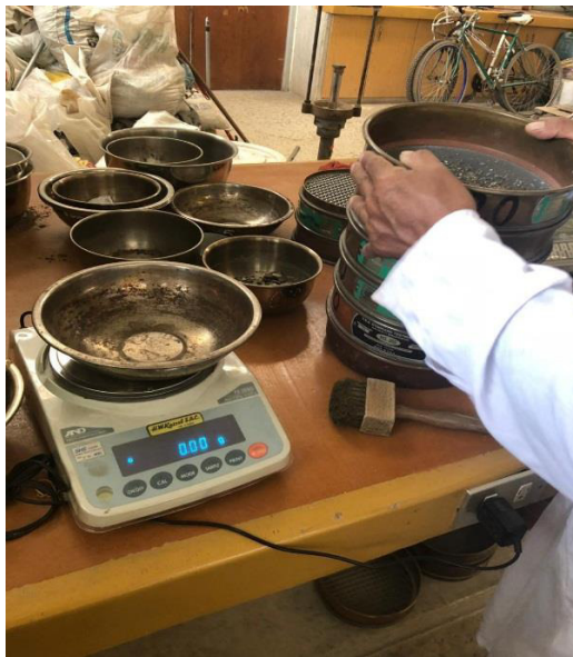
Figura 19. Ensayo de Granulometría por Tamizado
