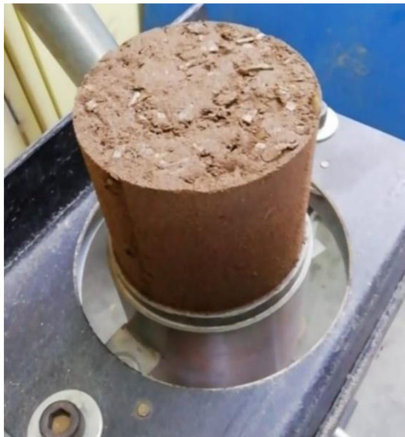
Figura 31. Extracción de la muestra compactada en un ensayo Proctor estándar Fuente: los autores
