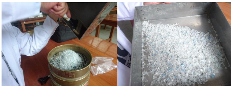
Figura 25. Tamizado y obtención de las escamas de tereftalato retenidas por la malla N° 4 y la N° 8 respectivamente
