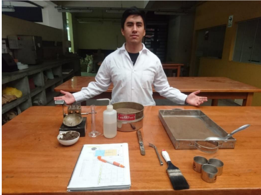
Figura 22. Materiales utilizados para el ensayo de Límite de Atterberg
