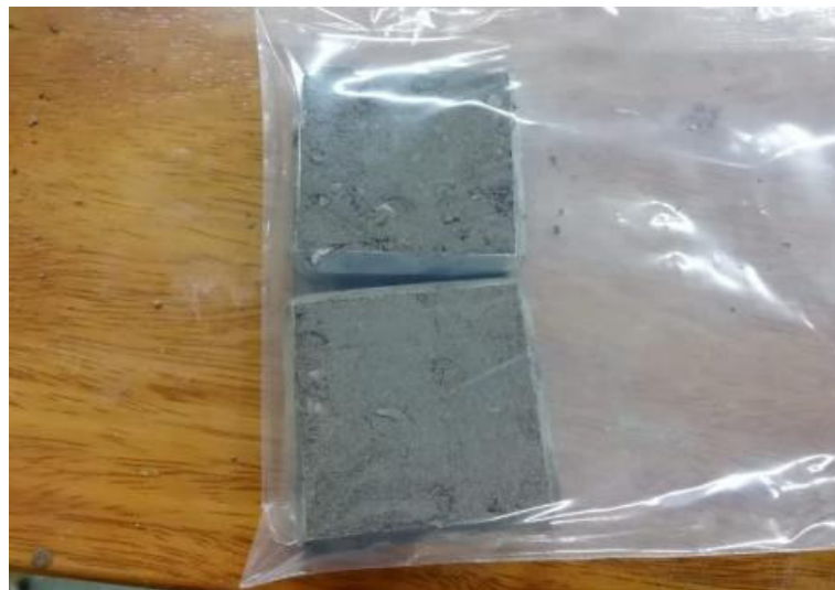
Figura 33. Guardado de los especímenes en una bolsa impermeable Fuente: los autores
