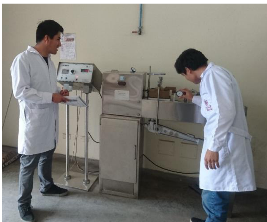
Figura 34. Lectura del desplazamiento y la fuerza registrada en la máquina de corte directo Fuente: los autores
