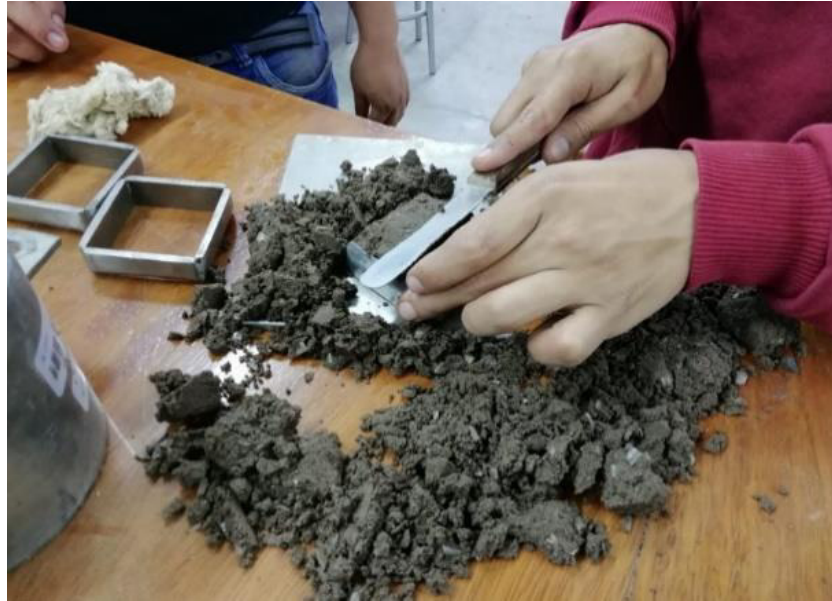
Figura 32. Remoldeo de los especímenes para la cámara de corte Fuente: los autores
