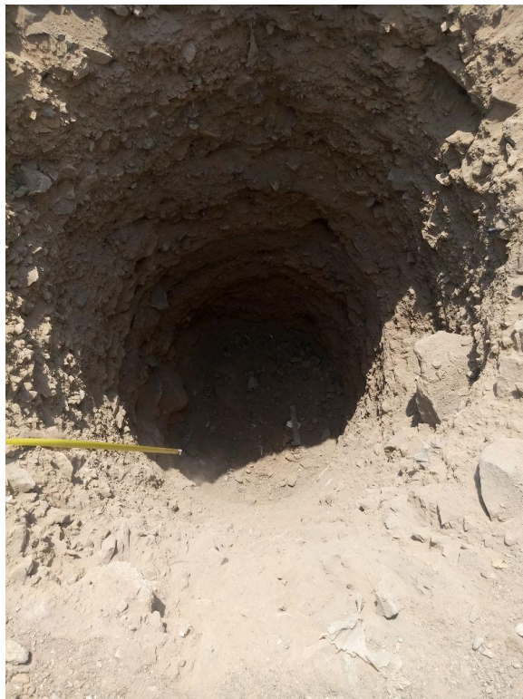
Foto 6. Excavación de donde se extrajo la muestra
