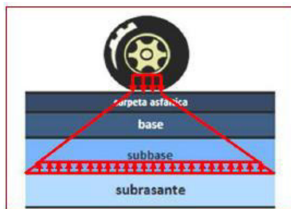
Figura 6. Pavimento frente a la carga de tránsito
