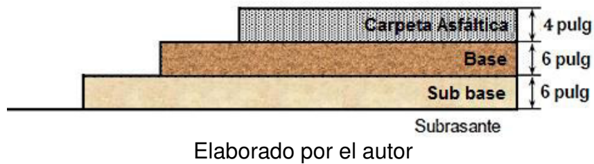
Figura 29. Distribución de alturas de las capas por el Método AASHTO 93
