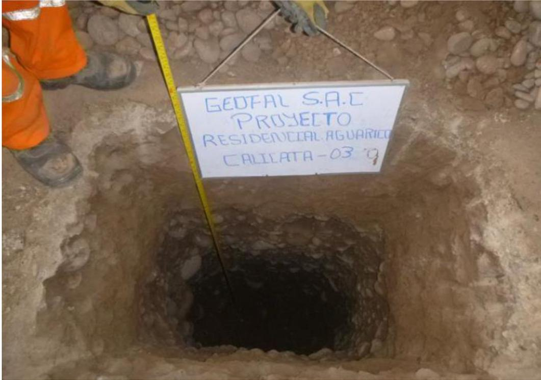
[Fotografía de calicata C-3]. (Excavación de la calicata C-3 para obtener las muestras). Proyecto Residencial Aguarico Breña - Lima
