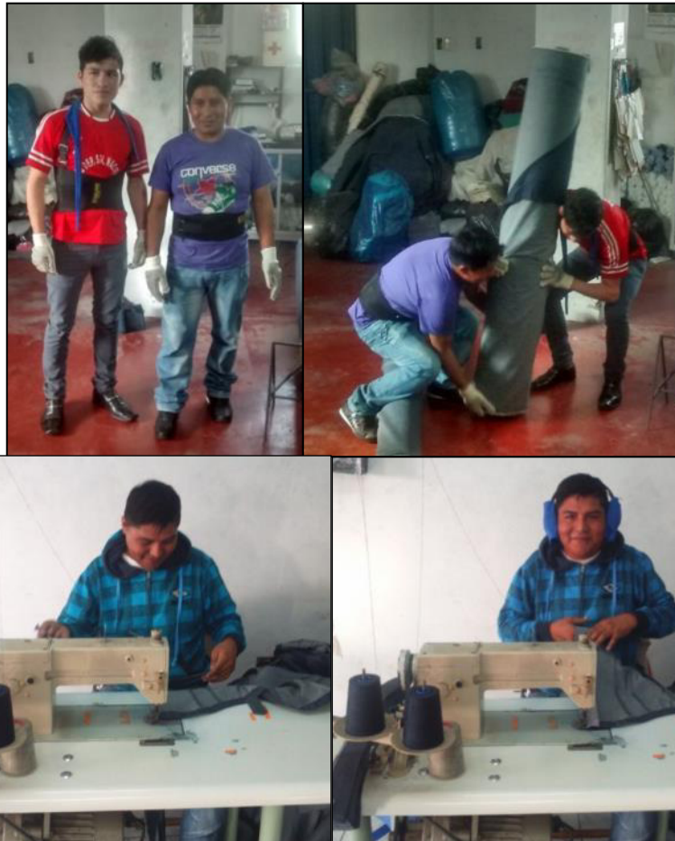
Figura 69. Colaboradores con EPP según labores que desempeñan. Arriba: colaboradores de área de almacenamiento y corte. Abajo: Costurero con orejeras para protección acústica
