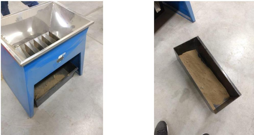
Figura: 57 Proceso para cuartear la muestra
