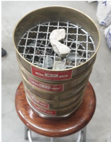
Figura: 58 Tamices considerados en el ensayo granulométrico
