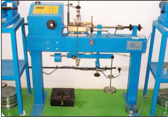
Figura: 18 Dispositivo para el ensayo de corte directo debe cumplir norma ASTM D-3080
