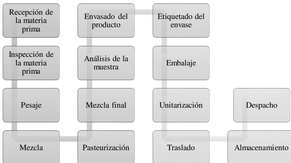
Figura 28 Proceso del producción de la vinagreta de sachá inchi
