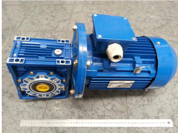
Figura 55. Motor reductor usado en el proyecto. Elaboración: los autores..
