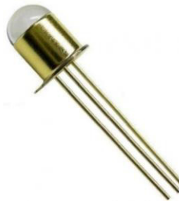
Figura 10. Fototransistor st-1kl3b, Fuente: KODENSHI KOREA CORP.
