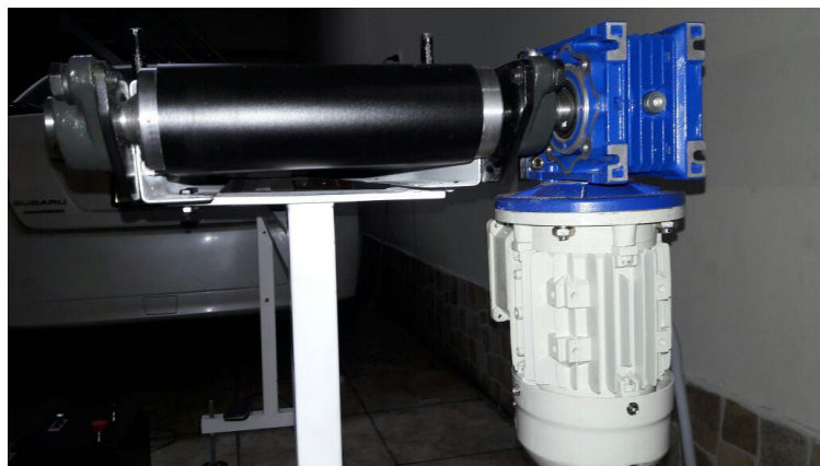
Figura 59. Moto reductor y motor trifásico Elaboración: los autores.
