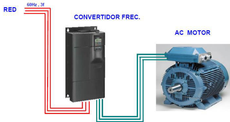
Figura 19. Instalación de un variador de velocidad. Fuente: Siemens, recuperado de conferencia de control velocidad
