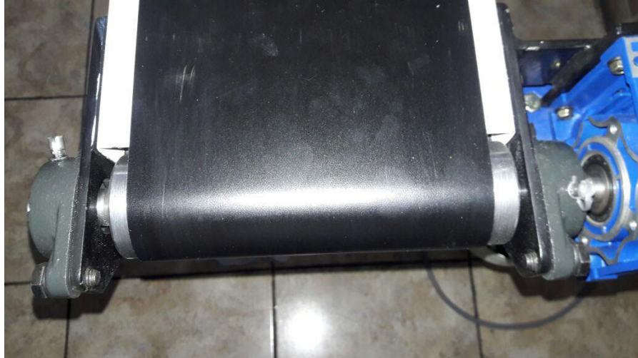
Figura 50. Chumaceras ensambladas con el rodillo Elaboración: los autores.
