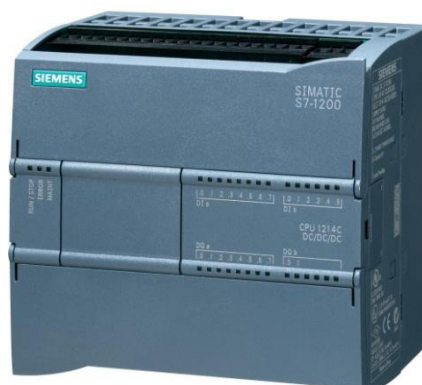
Figura 15. PLC s7-1200 CPU 1214C. Fuente: Siemens recuperado de su página web
