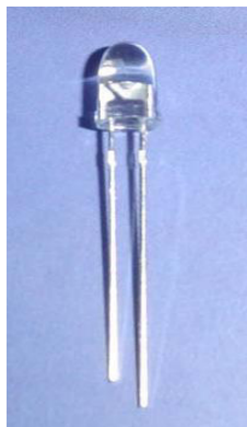
Figura 9. Led infrarrojo SIR383 Fuente: Everlight Electronics Co., Ltd.
