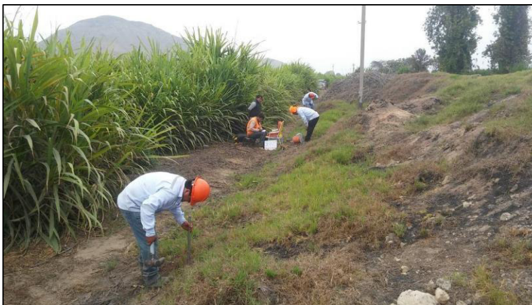
Foto N° 03.- Obsérvese la ejecución del SEV 03
