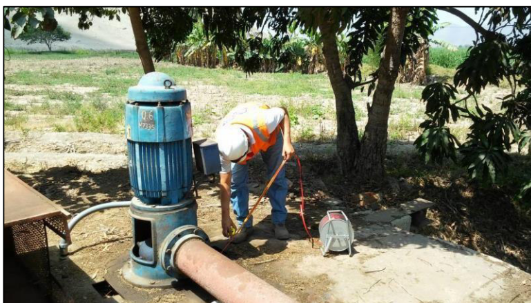
Foto N° 13.- Medición del nivel estático en el pozo IRHS 133 “Q-6”, sector Don Fernando - Paramonga
