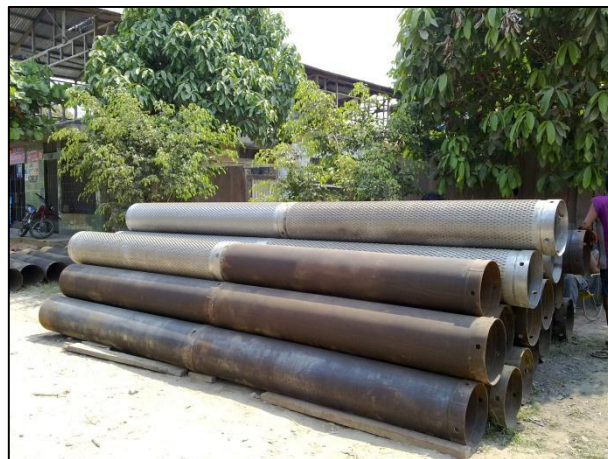
Figura 23 Tuberías de filtro y ciegas
