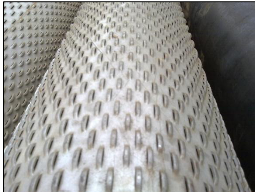
Figura 30 Tubería de filtro
