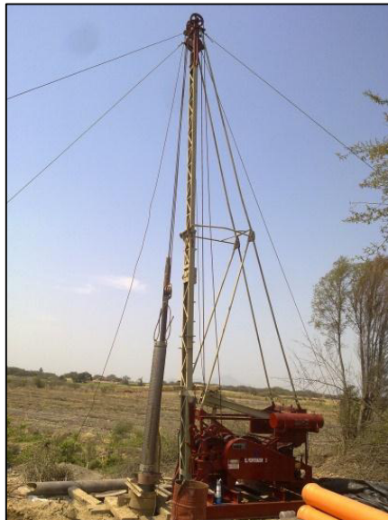
Figura 21 Maquinaria empleada para perforación a percusión
