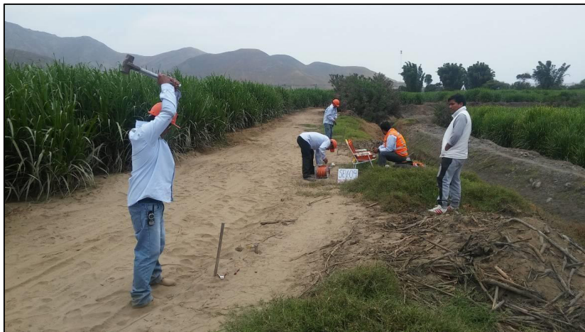
Foto N° 09.- Obsérvese la ejecución del SEV 09
