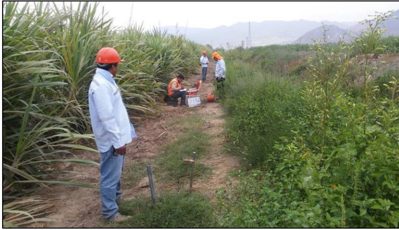
Foto N° 01.- Obsérvese la ejecución del Sondeo Eléctrico Vertical N° 01, predio Manzueto - Paramonga
