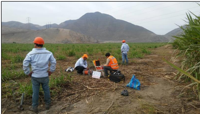
Foto N° 02.- Obsérvese la ejecución del SEV 02
