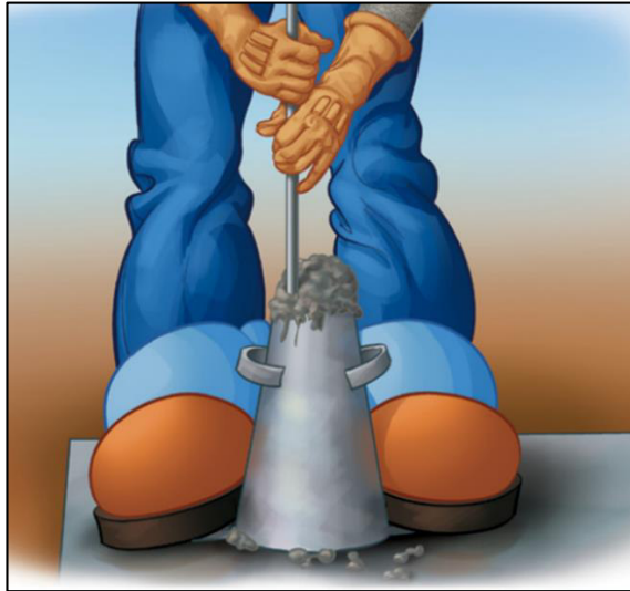
Figura 4: Compactación de la tercera capa de concreto Fuente: IMCYC., 2007
