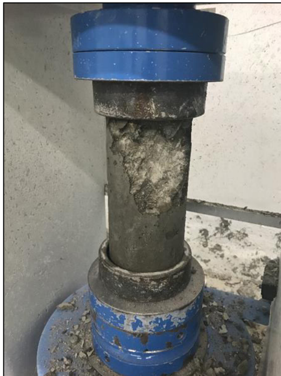
Figura 41: Probeta fallada por compresión axial Elaboración: los autores
