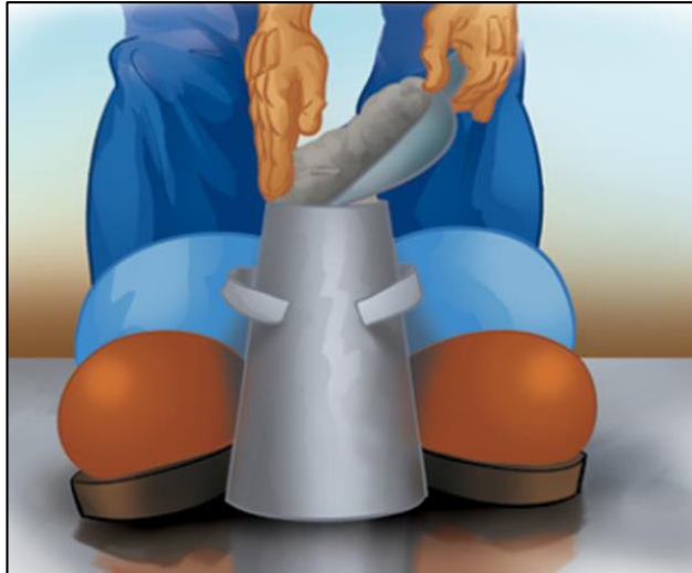
Figura 2: Llenado de la primera capa de concreto Fuente: IMCYC., 2007
