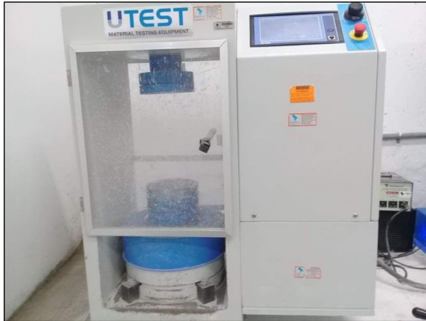
Figura 40: Prensa de concreto Elaboración: los autores
