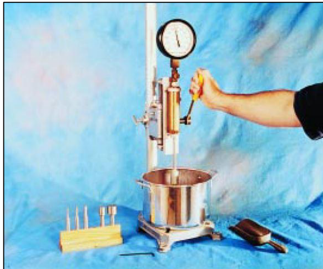
Figura 12: Equipo de tiempo de fraguado Fuente: Kosmatka et al., 2004
