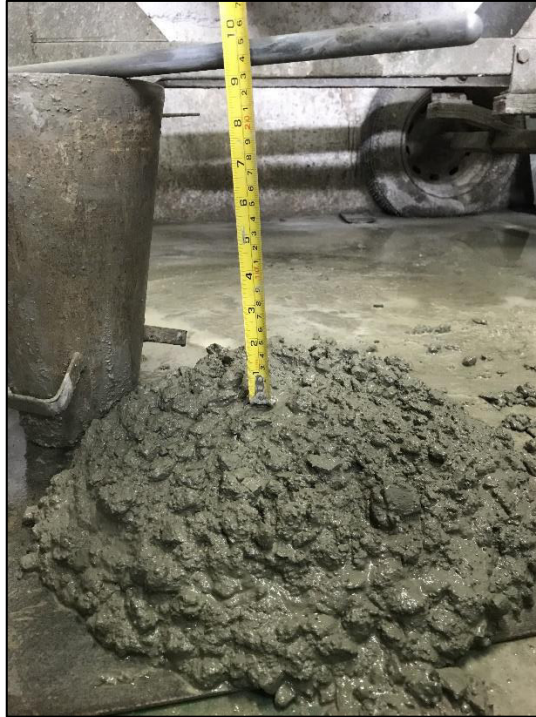
Figura 8: Ensayo de Asentamiento Elaboración: los autores
