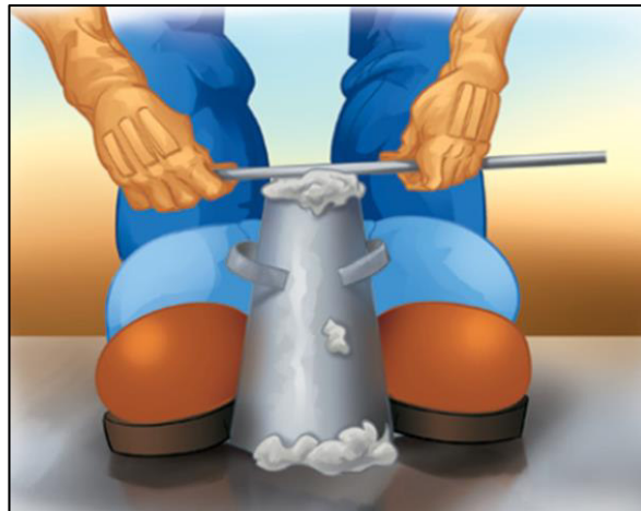
Figura 5: Enrasado con la varilla de compactación Fuente: IMCYC., 2007
