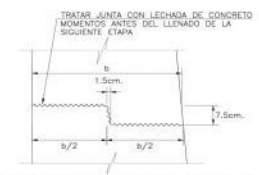
DETALLE JUNTA DE CONSTRUCCION EN MURO ESCALA : 1/10
