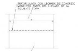
DETALLE JUNTA DE CONSTRUCCION EN MURO
