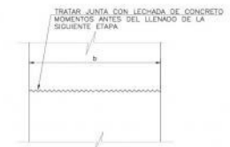
DETALLE JUNTA DE CONSTRUCCION EN MURO ESCALA: 1/10
