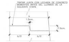
DETALLE JUNTA DE CONSTRUCCION EN MURO
