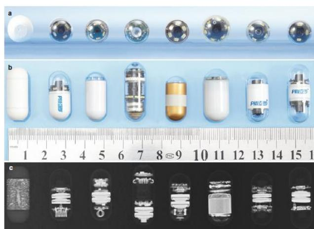
**Figura 3.** Modelos de Cápsula Endoscópica visión de frente (a) y por encima (b) de las VCE, con imagen radiológica (c). De izquierda a derecha: Agile patency capsule, PillCam SB2, EndoCapsule, CapsoCam, MiroCam, OMOM capsule, PillCam ESO2, PillCam COLON2 <sup>23</sup>
