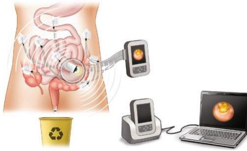
**Figura 5.** Esquema de la técnica de transmisión por radiofrecuencia<sup>23</sup>
