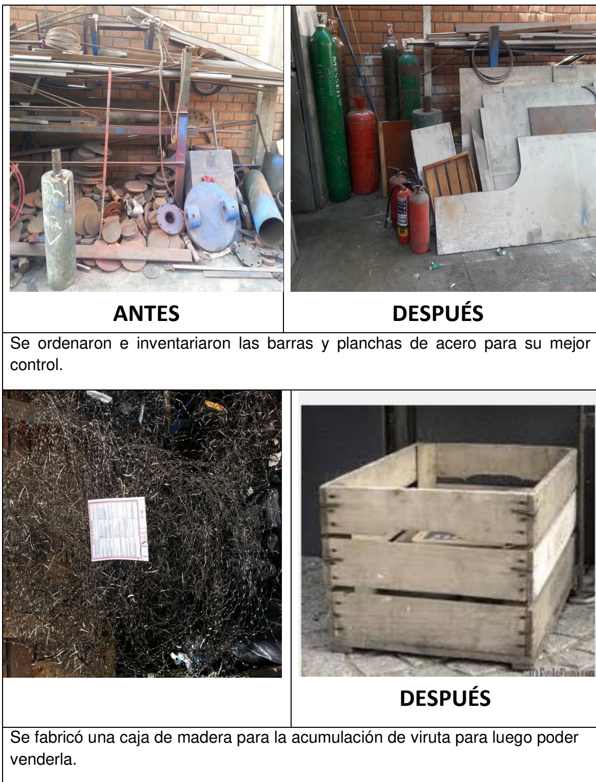
Figura 207. Ordenamiento de piezas y herramientas en el área de producción 4 Fuente: La empresa
