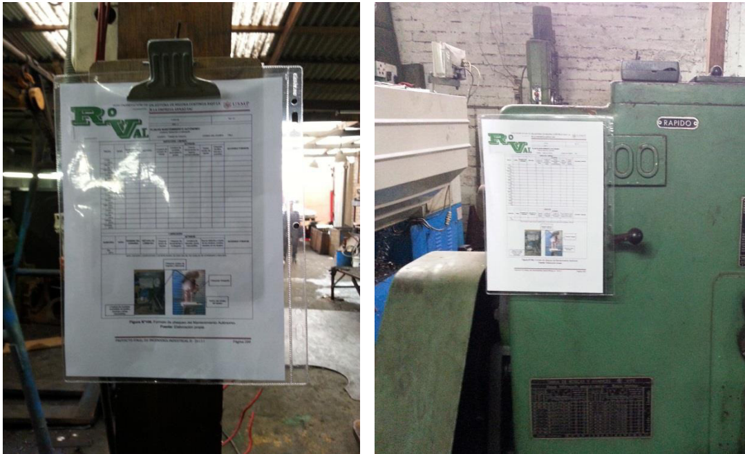
Figura 63. Registro de inventario de máquinas/equipos Fuente: La empresa
