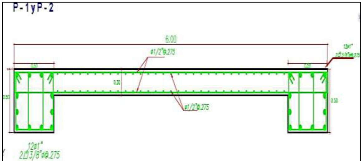
Figura 37: Sección transversal de las placas P-1 y P-2 con su respectivo refuerzo Fuente: Elaborado por los autores
