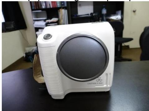
Figura 11: Vista superior del equipo radiográfico periapical
