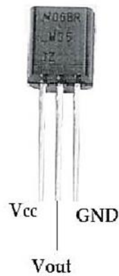
Figura N° 22: Se muestra el sensor de temperatura LM35.
