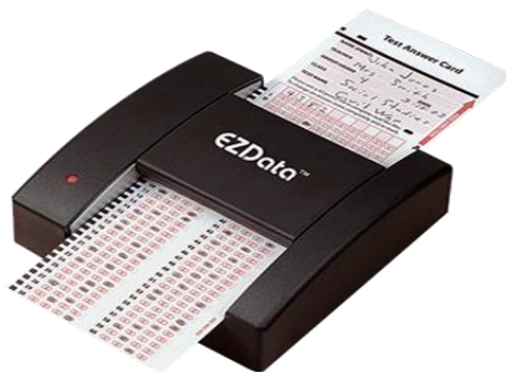
Figura N° 6: Se muestra la parte del hardware que utiliza la solución MarkQual para corrección de exámenes.
