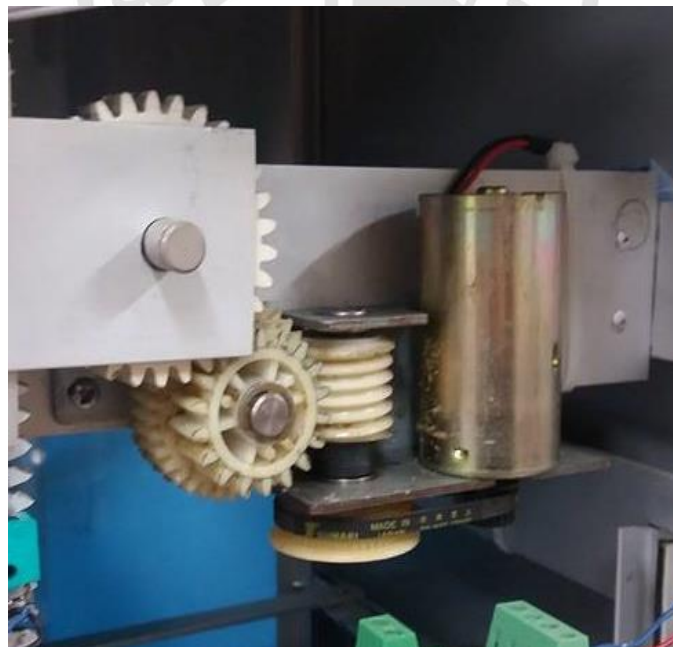
Figura 5: Se muestra el motor A (para el movimiento vertical del separador de cuadernillos)
