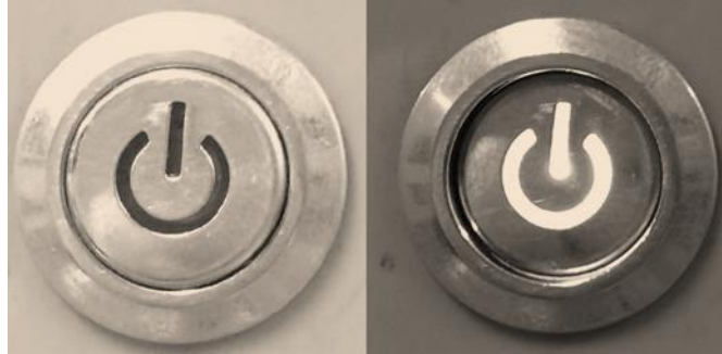
Figura Nº 88: Se muestra el control de intensidad del led por medio del PWM.
