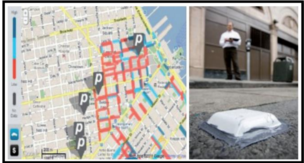
Figura 1.25. Sistema inteligente de Parking de San Francisco (visualización de plazas y sensores).
