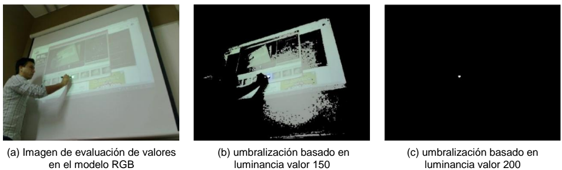
Fig. 24: Resultado prueba con diferentes valores de luminancia Elaboración: El autor
