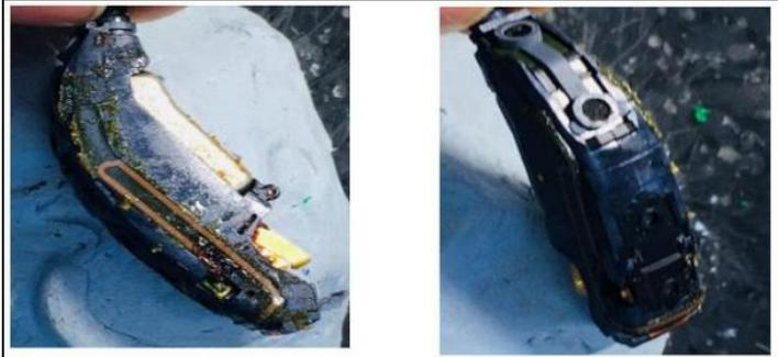
En base a estos informes, se evidencia que el exceso de humedad y cerumen en los dispositivos fue lo que causó que el audífono izquierdo dejara de funcionar, lo que constituyó un daño no reparable.
