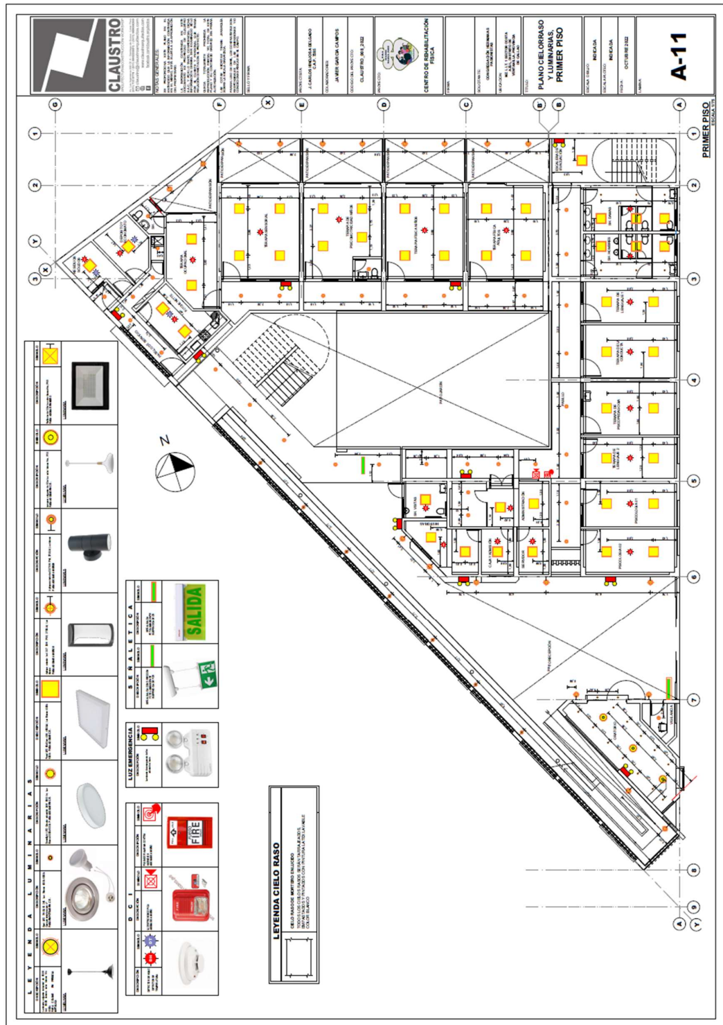
Figura 69. Detalle de cielos rasos y luminarias, Centro de Rehabilitación Física – Ventanilla.
