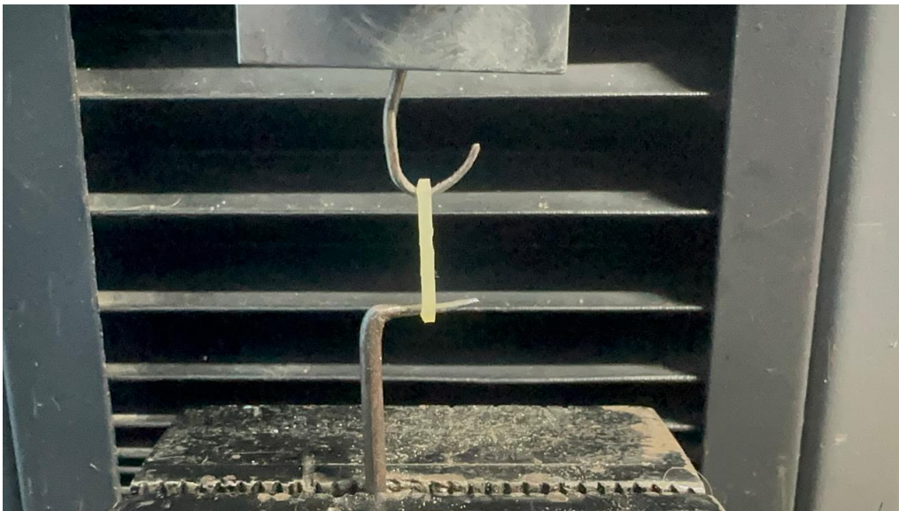
Figura 7-8: Vista de un elástico intermaxilar sometido al estiramiento en la máquina de ensayos.
