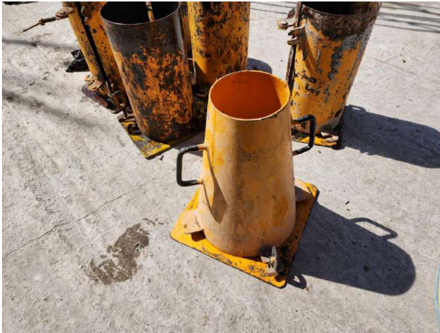
Figura 32. Cono de Abrahams para ensayo de trabajabilidad.
