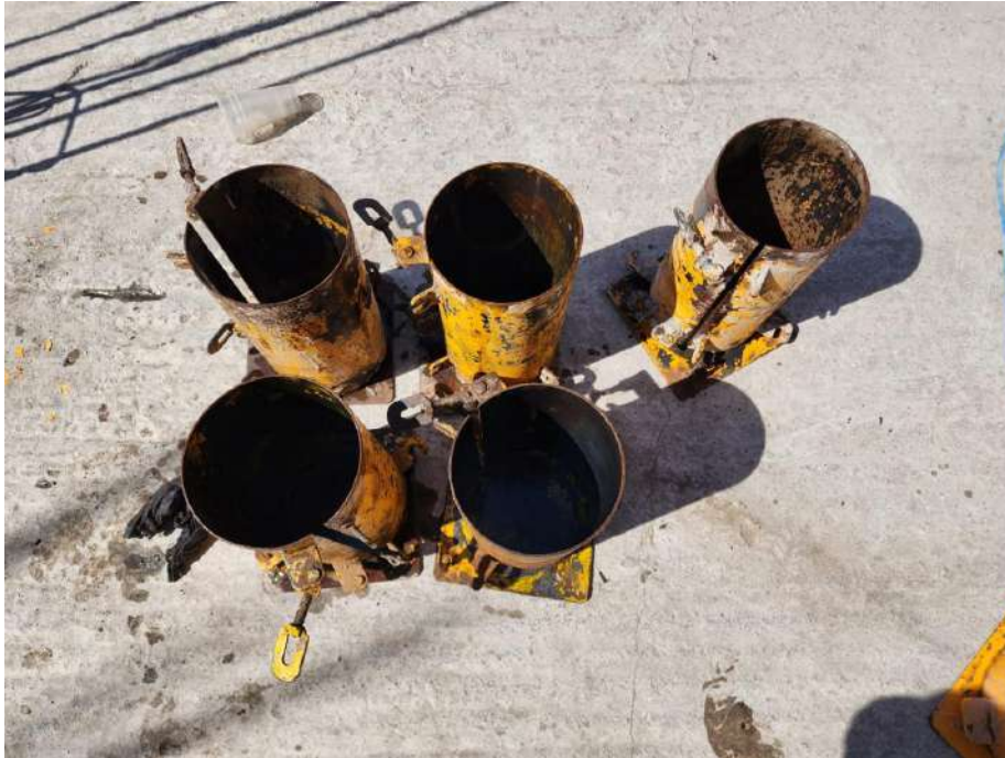
Figura 33. Moldes para probetas de concreto.
