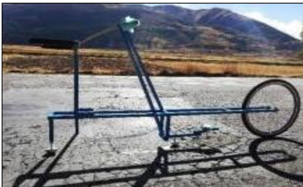
Figura 10. Rugosímetro de Merlín
