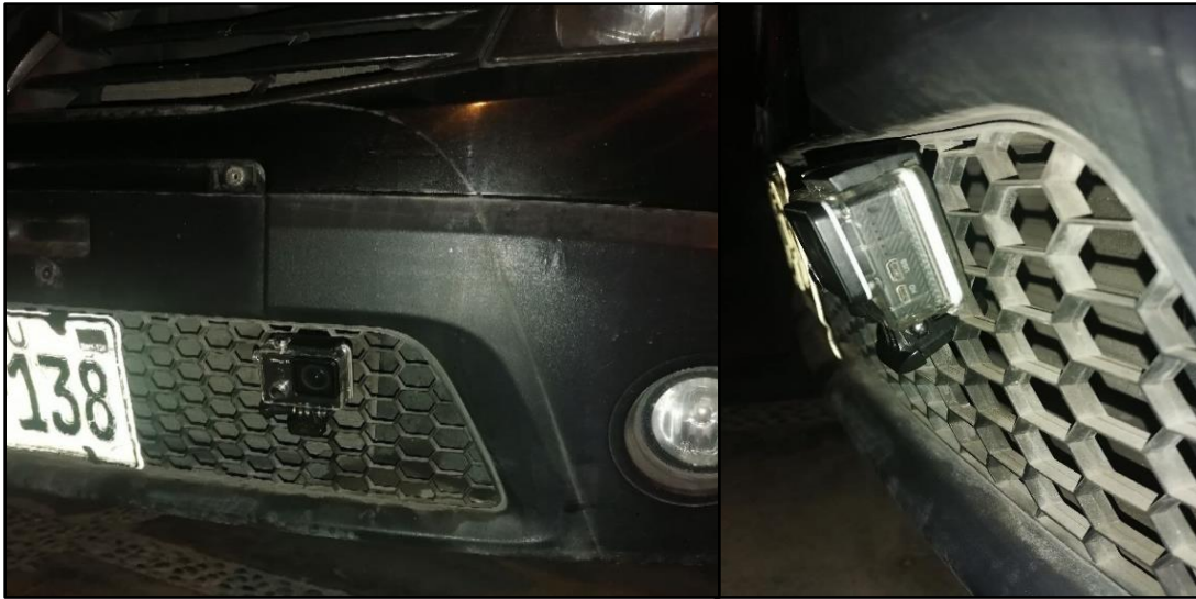
Figura 49. Instalación de Cámara GoPro
