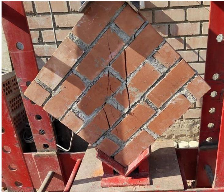
Si la adherencia entre la unidad y el mortero no es óptima, la falla se produce de manera escalonada a través de las juntas o de manera mixta, involucrando tanto las juntas escalonadas como el corte de las unidades.
