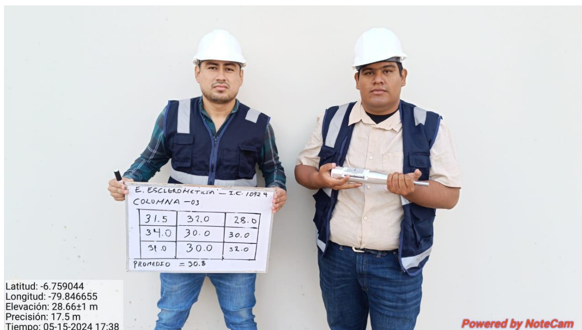
Figura 36. Ensayo de esclerometría in -situ
