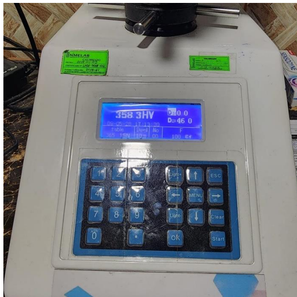
Imágen N° 9: Microdurómetro analizando una muestra
