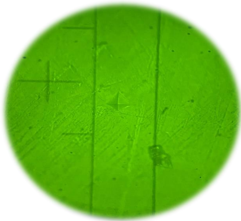
Imagen N° 12: Evaluación óptica en el microdurómetro (50x de aumento)
