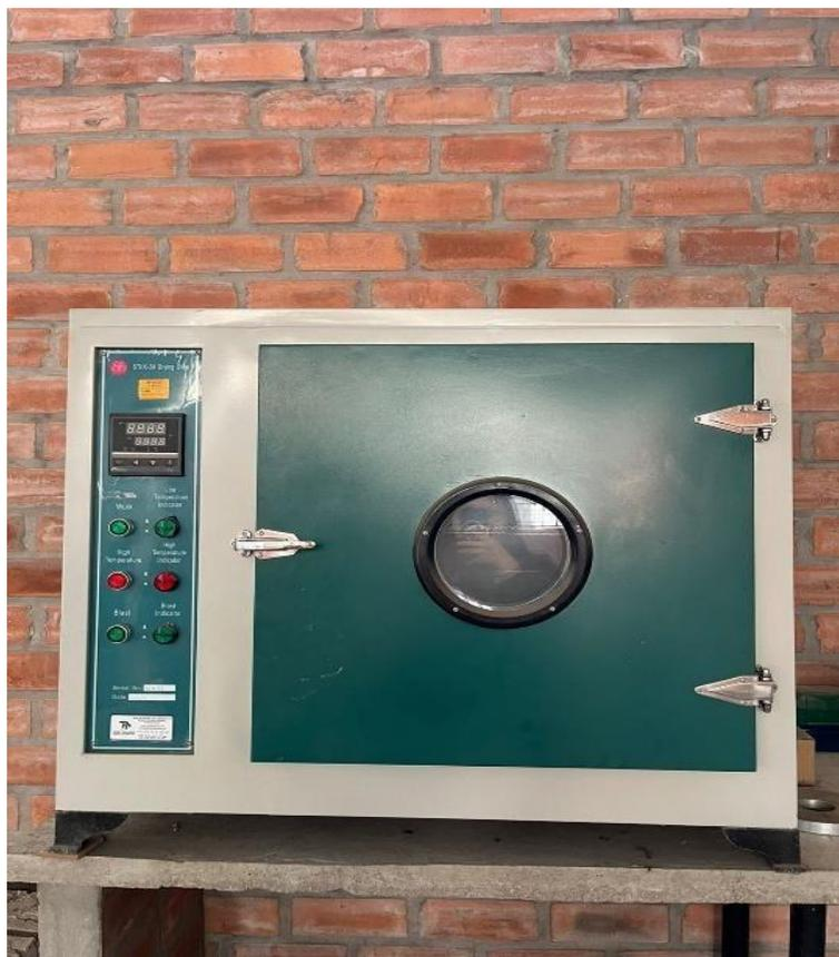
*Nota.* Horno de secado a temperatura específica. Fuente: Elaborado por los autores.
