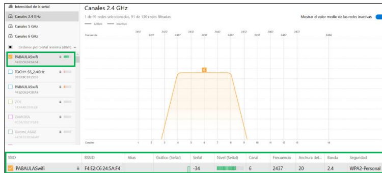
Figura 104 Intensidad de Señal en NetSpot- Pasadizo Quinto Nivel
