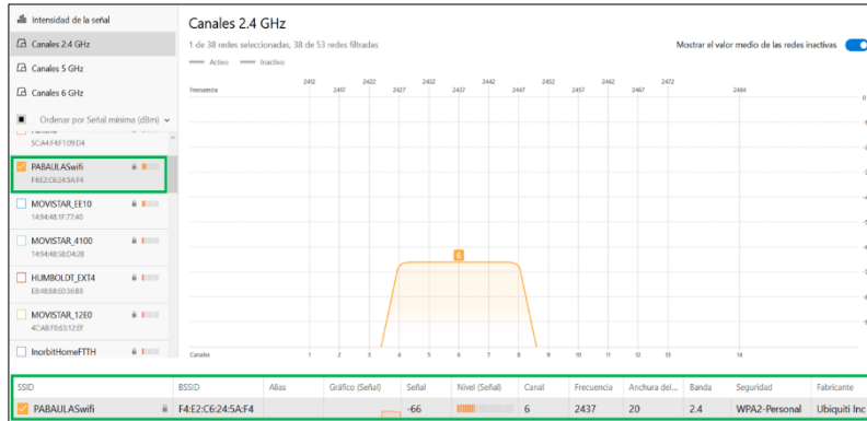
Figura 70 Intensidad de Señal en NetSpot- Aula 205
