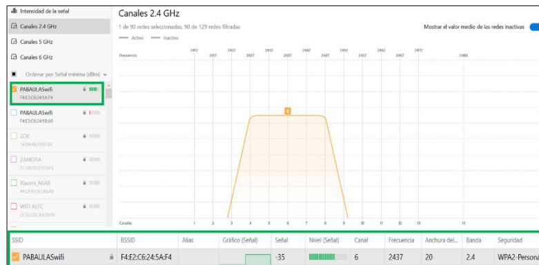
Figura 72 Intensidad de Señal en NetSpot - Pasadizo Segundo Nivel
