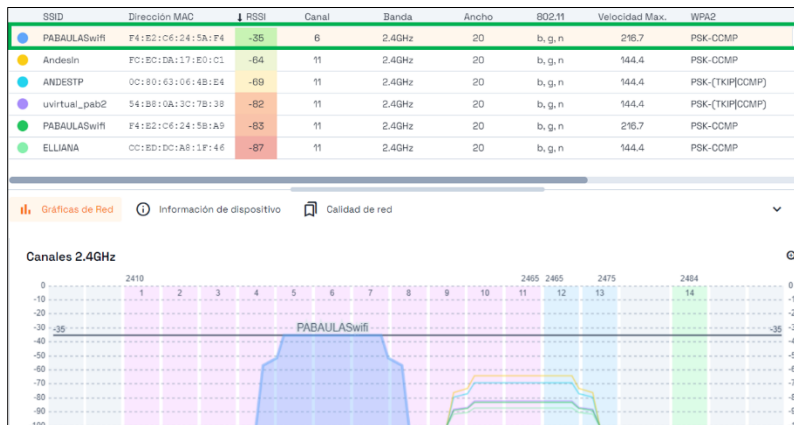
Figura 71 Intensidad de Señal en Acrylic Wifi- Pasadizo Segundo Nivel
