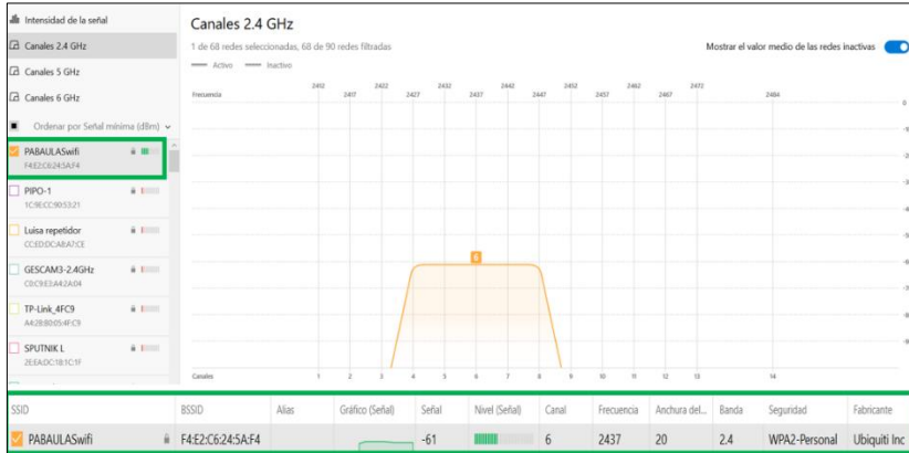
Figura 66 Intensidad de Señal en NetSpot- Aula 203
