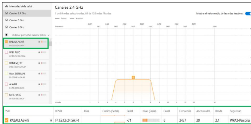
Figura 62 Intensidad de Señal en NetSpot- Aula 201
