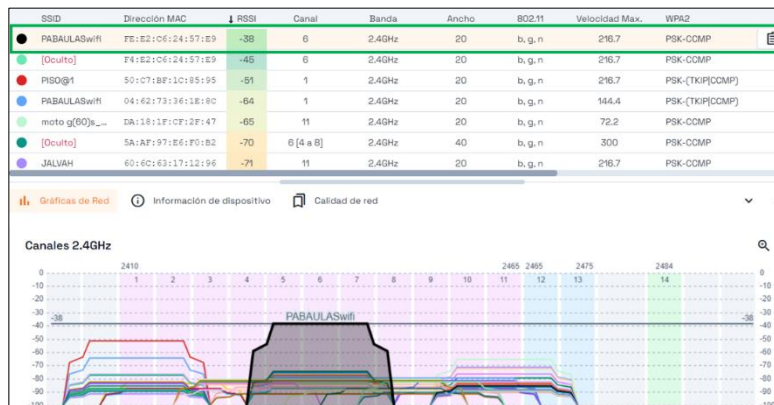
Figura 95 Intensidad de Señal en Acrylic Wifi- Pasadizo Cuarto Nivel
