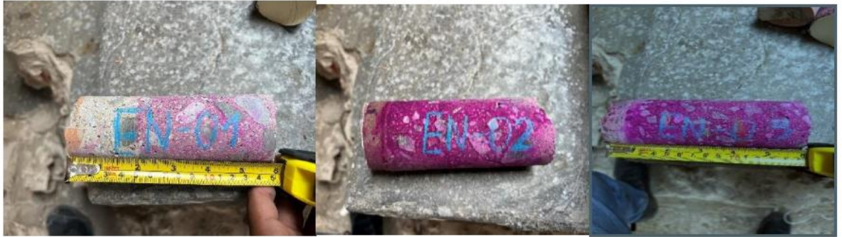
Figura 14. Resultados prueba de carbonatación Adaptado de proyecto unifamiliar Esta prueba se le realizó a los testigos de concreto, obteniendo los siguientes resultados:
