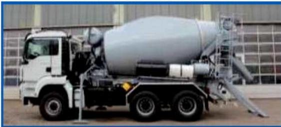
Figura 1: Camión hormigonera
