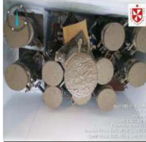
FOTO N°50 CURADO EN CAMARA DE REFRIGERACION
