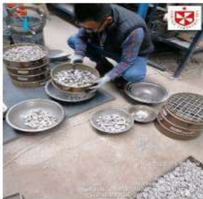
FOTO N°17 TAMIZADO DEL AGREGADO GRUESO
