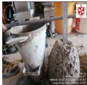
FOTO N°56 PRUEBA DEL SLUMP
