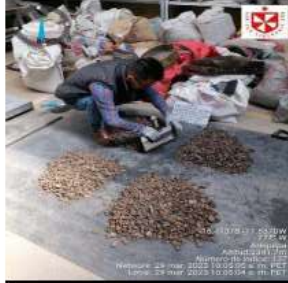
FOTO N°14 CUARTEO DEL AGREGADO GRUESO
