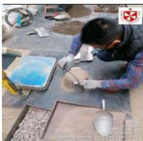
FOTO N°20 PESO UNITARIO DEL AGREGADO FINO
