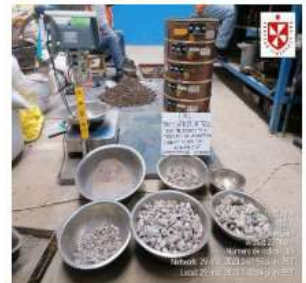
FOTO N°18 SELECCIÓN POR PESO DEL AGREGADO GRUESO
