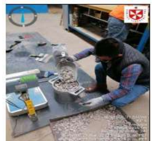
FOTO N°21 PESO UNITARIO DEL AGREGADO GRUESO
