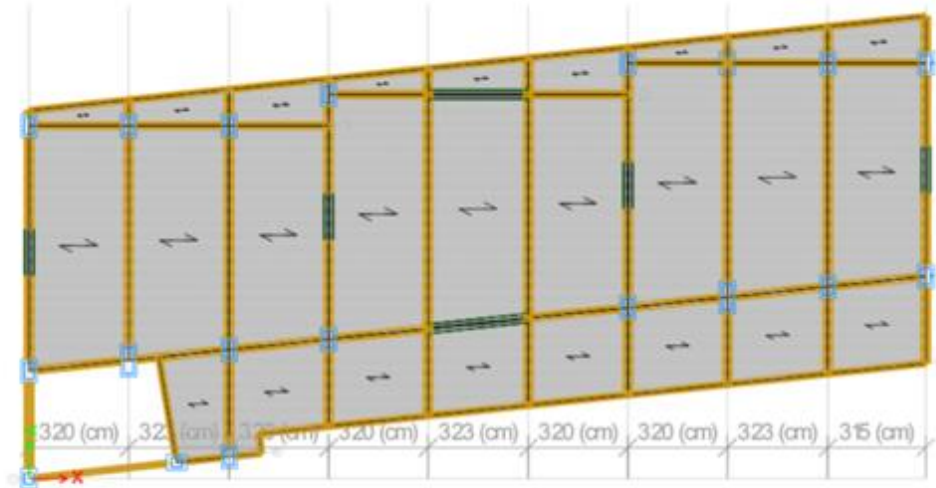
A: Reforzamiento mediante encamisado de columnas y adición de placas de concreto.
