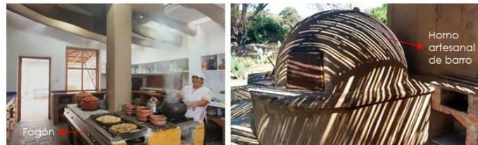
En la cocina, se construyó con muros bajos, dejando unas aberturas donde se colocan por debajo la leña, de altura 90 cm, así como las viviendas originarias de Túcume, usando un tipo de fogón, y encima van varias hornillas, para poner las vasijas de barro. También en el exterior al lado de la cocina, se ubica el horno hecho en barro, para hacer el pan artesanal.
