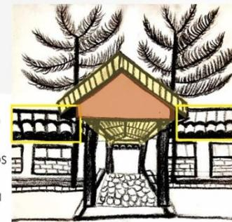
2 Sist. constructivo de material noble, más Bambú. En los techos la estructura está hecha de madera y bambú, con cerramientos externos horizontales de tejas.
