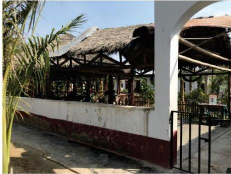
Sistema constructivo de bambú, con tijerales, en la zona de comidas. Sistema constructivo convencional para el resto de estructuras y 1 zona de comidas.
