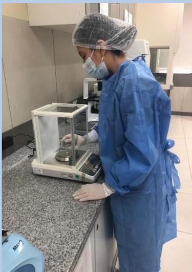
Figura 13. Pesaje inicial de las muestras de las resinas Filtek™ Bulk Fill (3M-Espe) y Tetric N-Ceram™ Bulk Fill (Ivoclar Vivadent) en la balanza electrónica analítica digital de precisión.
