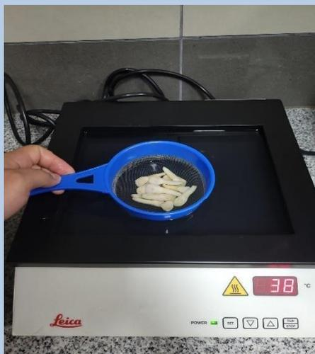
Figura 2. Exposición de las muestras a una fuente de agua desionizada a  $37\pm 2^{\circ}\text{C}$  durante 60 segundos.
