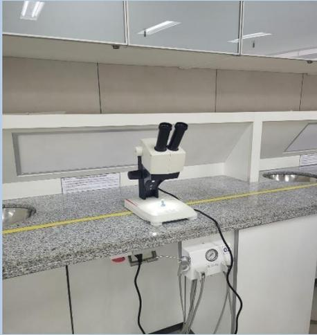
Figura 4. Estereomicroscopio utilizado para analizar la penetración del azul de metileno en las muestras.
