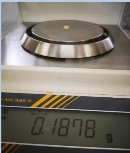
Figura 17. Pesaje de las muestras en la balanza electrónica analítica de precisión.
