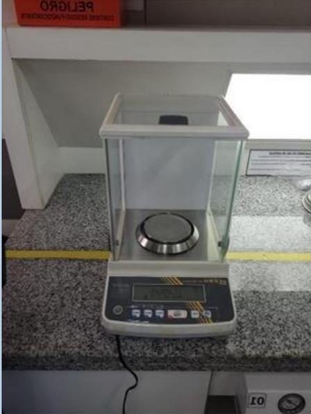
Figura 11. Balanza electrónica analítica digital de precisión.
