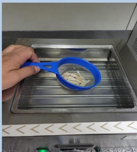
Figura 3. Exposición de las muestras a una fuente de agua desionizada a  $55\pm 2^{\circ}\text{C}$  durante 60 segundos.
