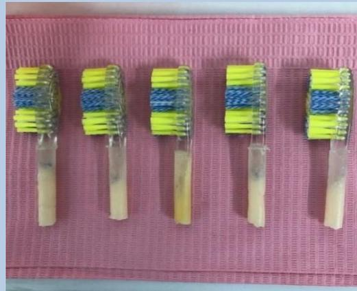
Figura 12. Preparación de cepillos para máquina de cepillado.
