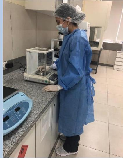
Figura 16. Pesaje final de las muestras de las resinas Filtek™ Bulk Fill (3M-Espe) y Tetric N-Ceram™ Bulk Fill (Ivoclar Vivadent) en la balanza electrónica analítica digital de precisión.
