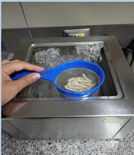
Figura 1. Exposición de las muestras a una fuente de agua desionizada a  $5\pm 2^{\circ}\text{C}$  durante 60 segundos.
