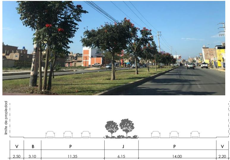
Figura 53: Sección Vial - Prolongación Bolognesi
