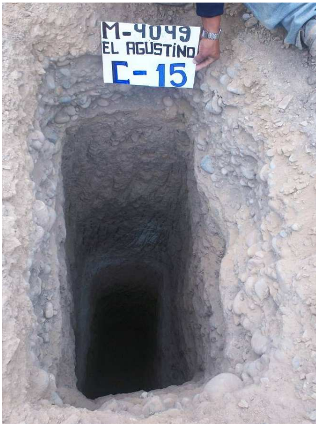
VISTA HACIA EL INTERIOR DE LA CALICATA C-15. SE APRECIA UNA CAPA DE RELLENO LIMPIO DE GRAVA ARENOSA, SOBRE UNA LOSA DE CONCRETO Y MAS ABAJO LOS ESTRATOS DE ARCILLA LIMOSA.
