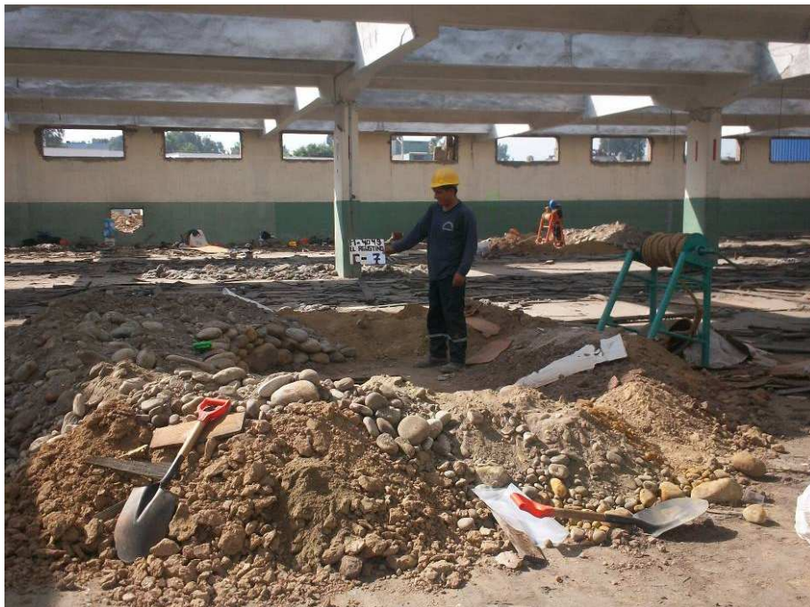
UBICACIÓN DE LA CALICATA C-7. SE APRECIAN LAS PIEDRAS Y BOLONES REDONDEADOS EXTRAÍDOS DE LA EXCAVACIÓN.
