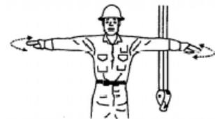
Parada de emergencia. Mantener la postura rígida, con ambos brazos extendidos y las palmas hacia abajo, desplazarlos adelante y atrás de manera continua.
