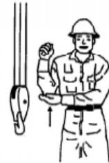
Usar el Guinche auxiliar. Colocar el brazo izquierdo debajo del codo del brazo derecho
