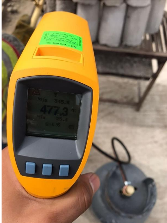
Figura 55. Medición de temperatura con pirómetro
