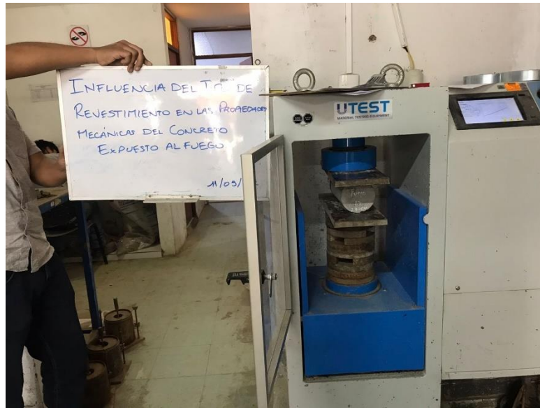
Figura 69. Ensayo a compresión
