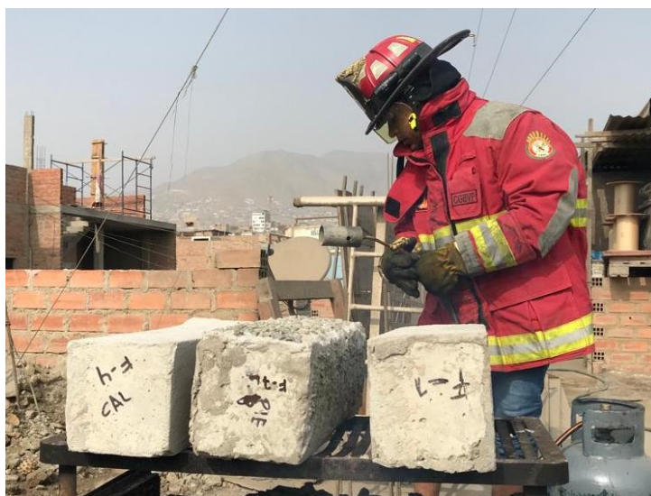
Figura 64. Soplete y fuego clase A en vigas
