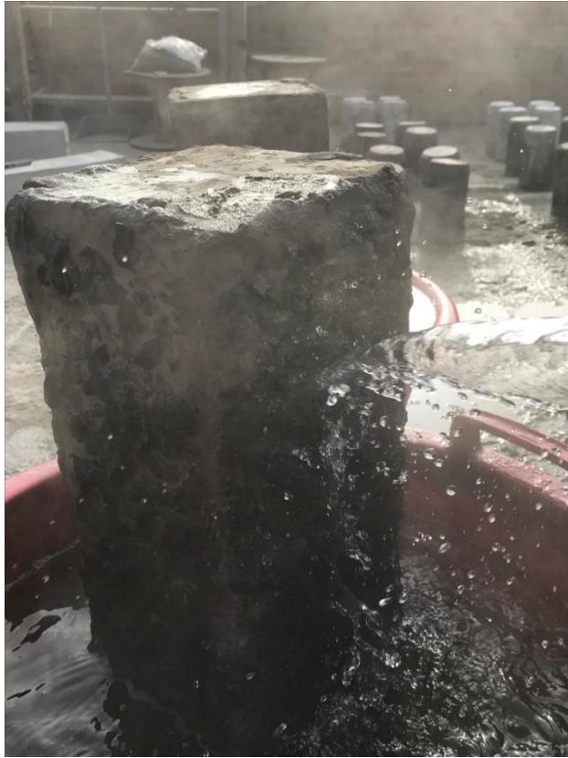
Figura 65. Enfriamiento de viga
