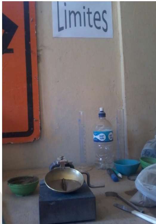
Figura N° 24. Determinando número de golpes por Casagrande Elaboración: El autor
