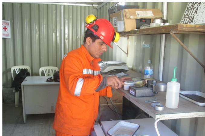
Figura N° 23. Realizando ensayo para límite líquido con equipo Casagrande Elaboración: El autor
