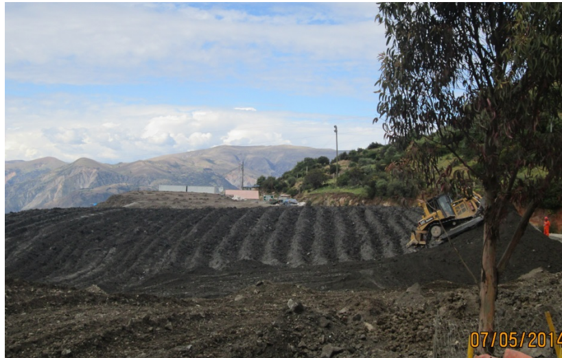
Figura N°14. Secado de relave en Amanda1, mediante surcado Elaboración: El autor
