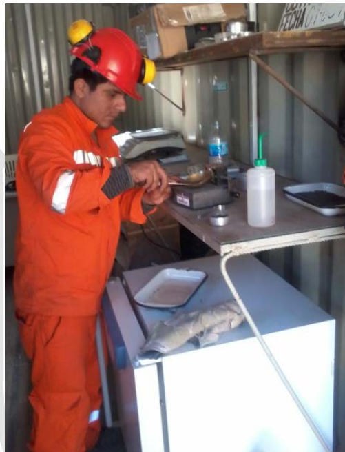
Figura N° 22. Secado de muestra en el horno Elaboración: El autor
