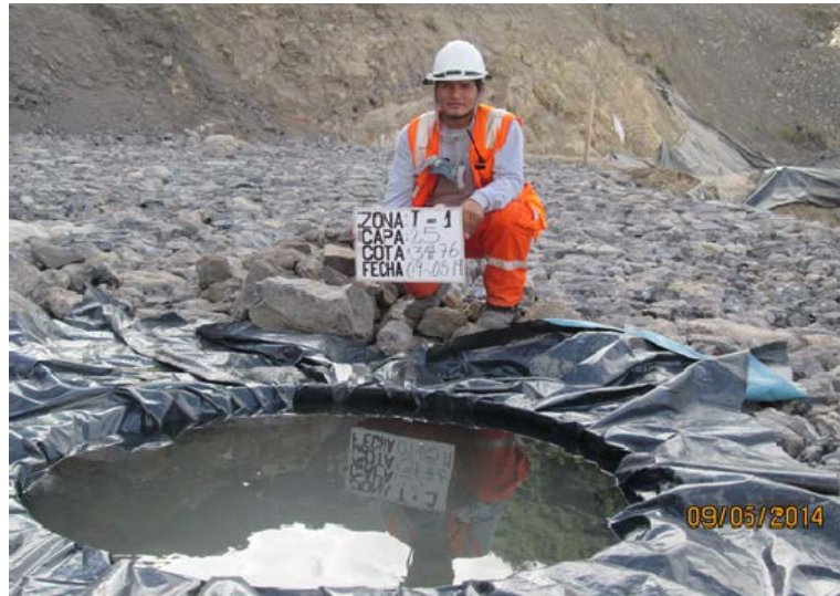
Figura N°08: Realizando la prueba de pedraplén, el hueco tiene 1,50m de diámetro con 50cm de profundidad
