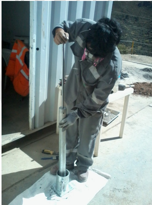
Figura N° 38. Capas de 5; cada capa 25 golpes con martillo
