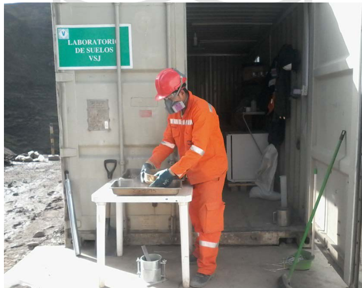
Figura N° 29. Tamizado de muestra para análisis granulométrico
