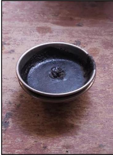
Figura 31: Combinación de agregado grueso con cemento asfáltico
