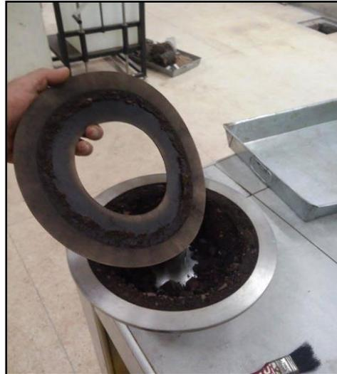
Figura 21: Anillos filtrantes para separación de material
