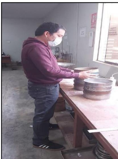
Figura 23: Granulometría del agregado grueso
