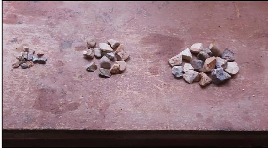
Figura 28: Separación de agregados en función a sus tamices
