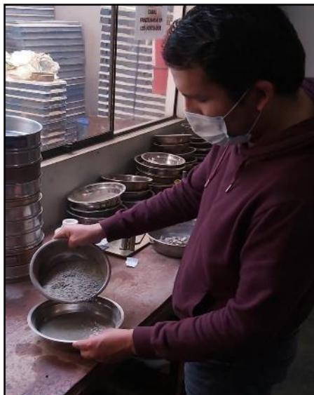
Figura 35. Combinación de materiales con sulfato de magnesio
