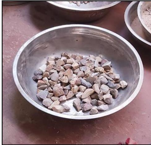
Figura 26: Saturación del agregado en agua por 16 horas
