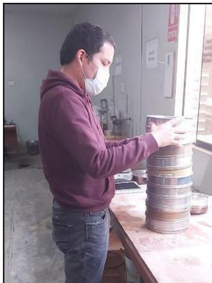
Figura 22: Granulometría del material reciclado
