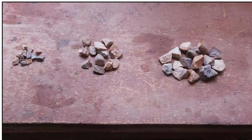
Figura 29: Separación de agregados en función a sus tamices
