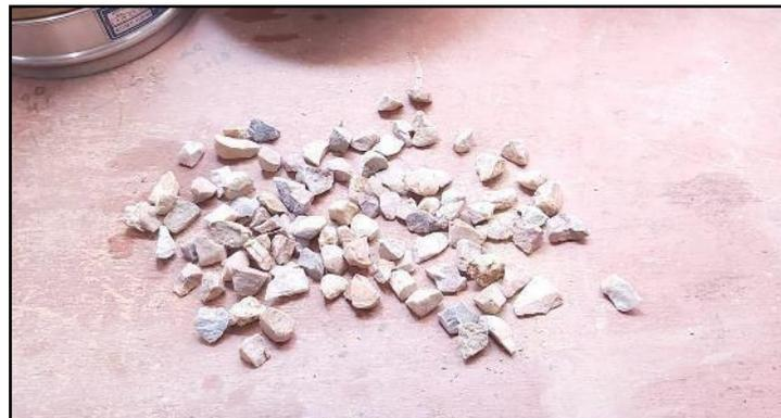
Figura 27. Agregados para ser separados según ancho y longitud
