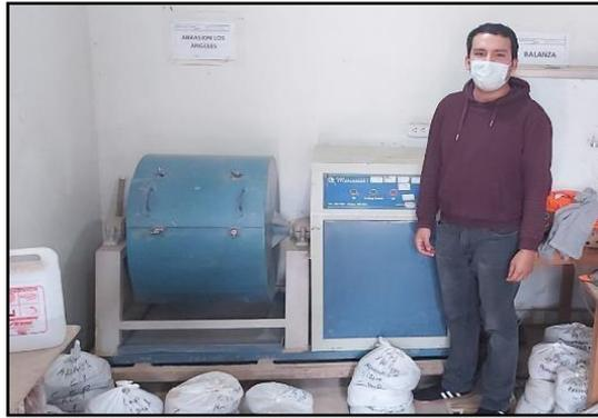
Figura 25: Máquina de Ángeles en proceso de gradación
