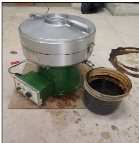
Figura 20: Proceso de extracción de materiales en maquina separadora
