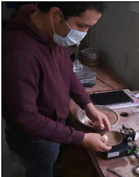
Figura 40. Agregado fino en maquina Cuchara Casagrande
