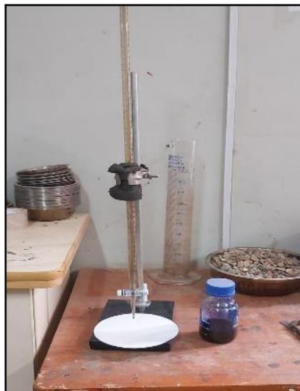
Figura 42: Varilla de vidrio con azul metileno
