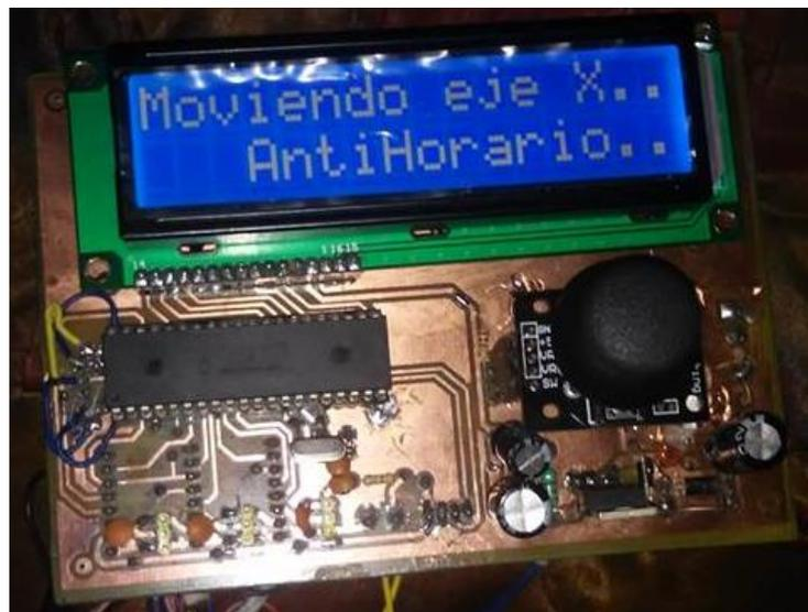
**Figura 5.20:** Interfaz de salida mediante un LCD, perteneciente al movimiento de la primera articulación del brazo robot relacionado al eje x.
