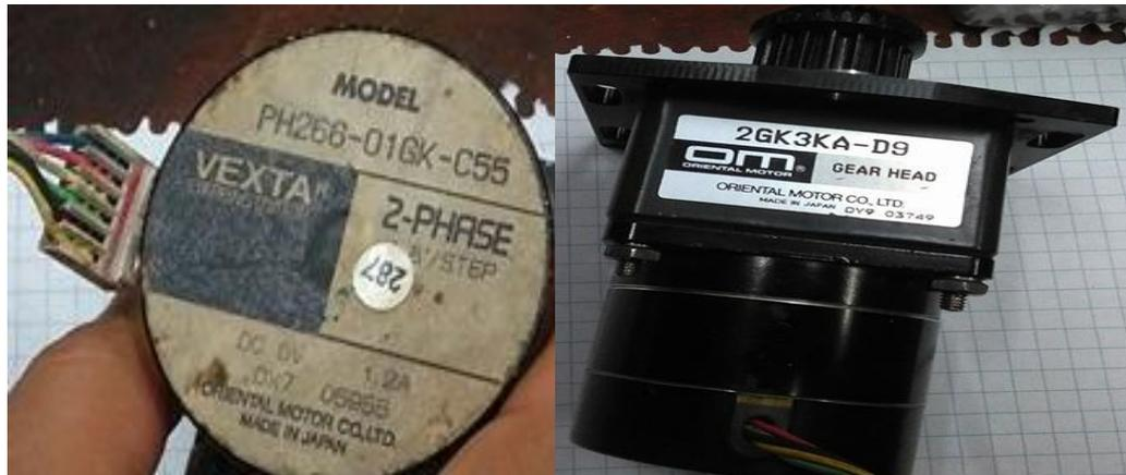
**Figura 5.9:** Motor y reductor de la segunda articulación del brazo robot
