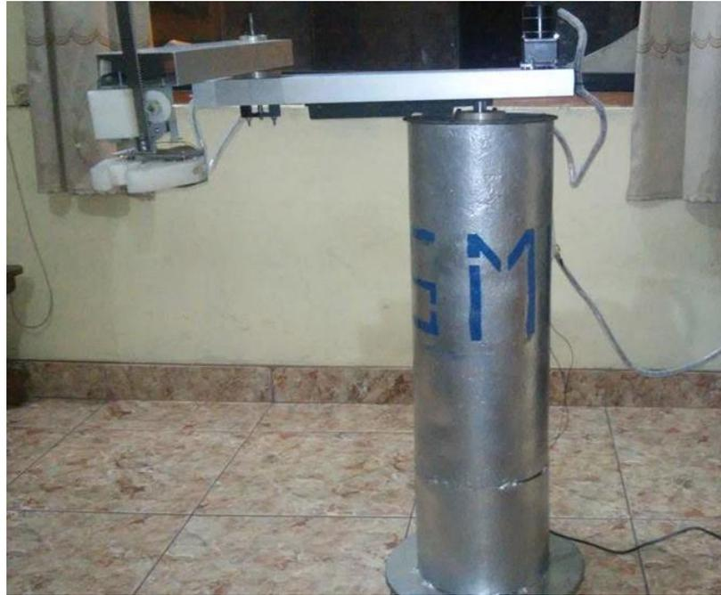
**Figura 5.23:** Brazo robot SCARA
