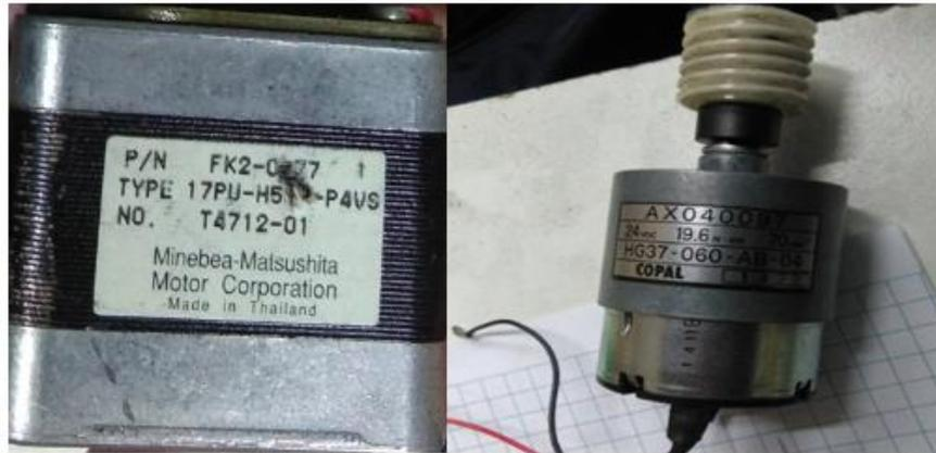
**Figura 5.10:** Motores para la articulación prismática y para el gripper
