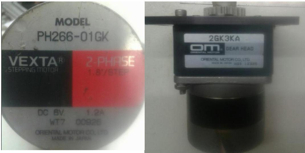
**Figura 5.8:** Motor y reductor de la base del brazo robot
