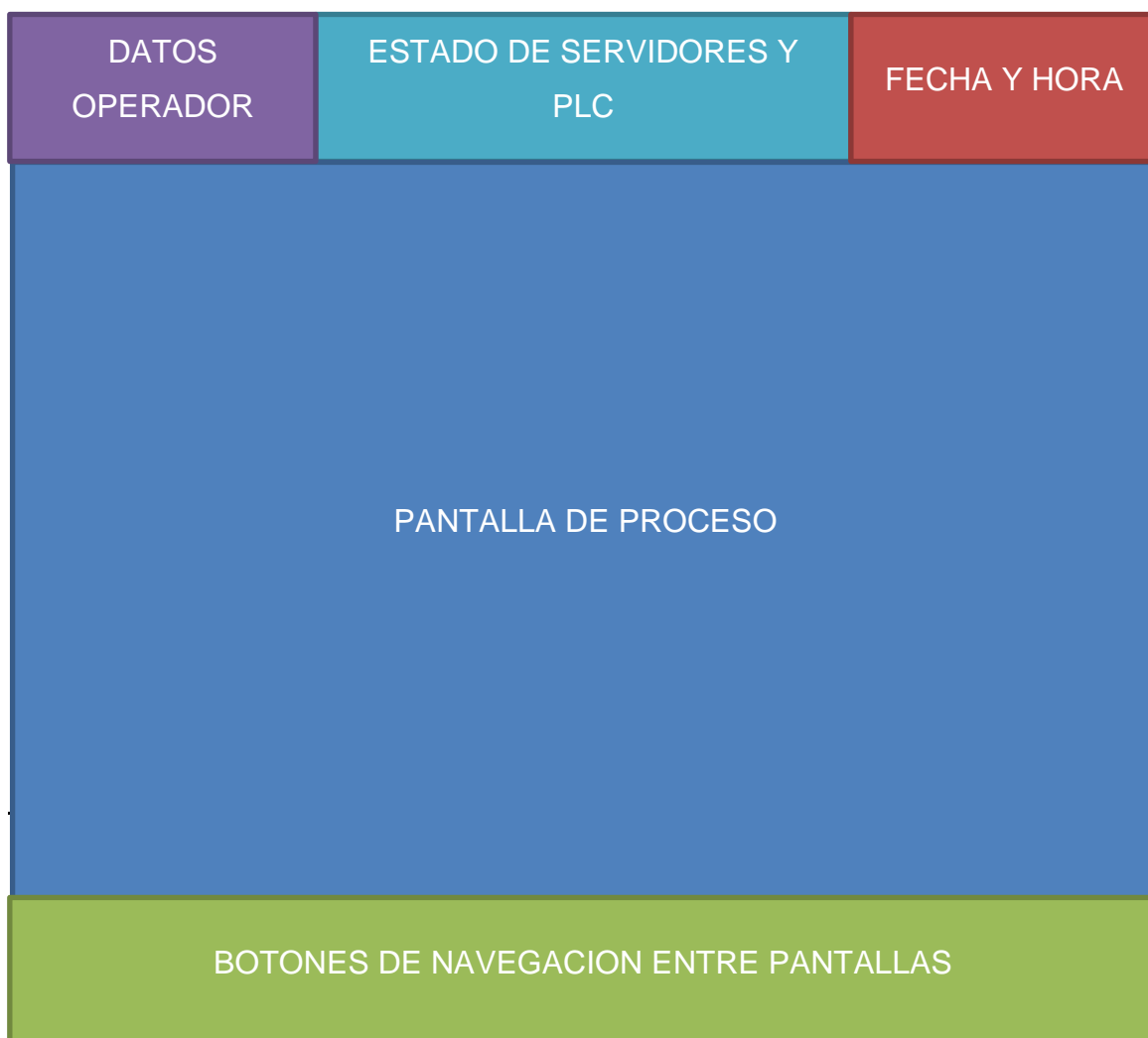
Figura 107: Distribución del área de las pantallas del SCADA.
