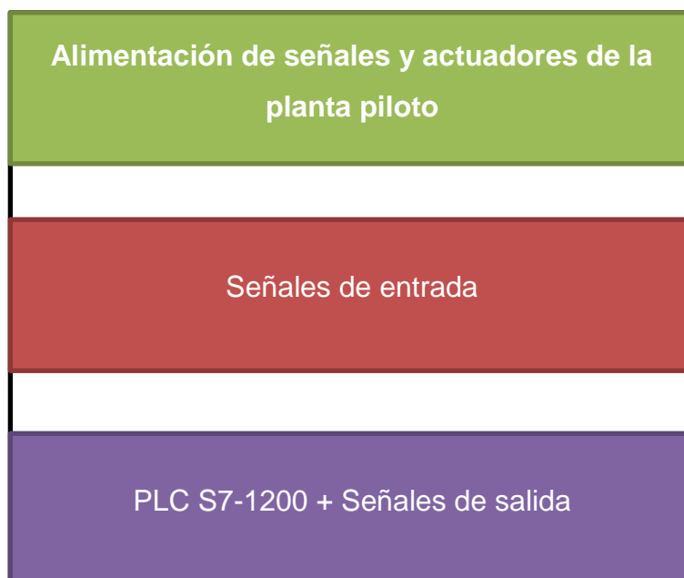
Figura 57: Distribución general del tablero eléctrico.
