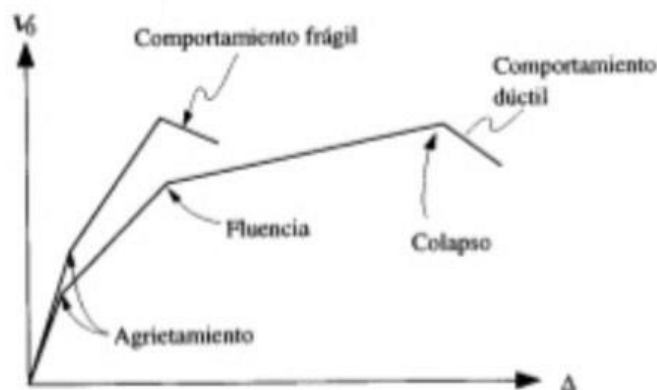
Figura 3. Relación Carga - Deformación de una Estructura
