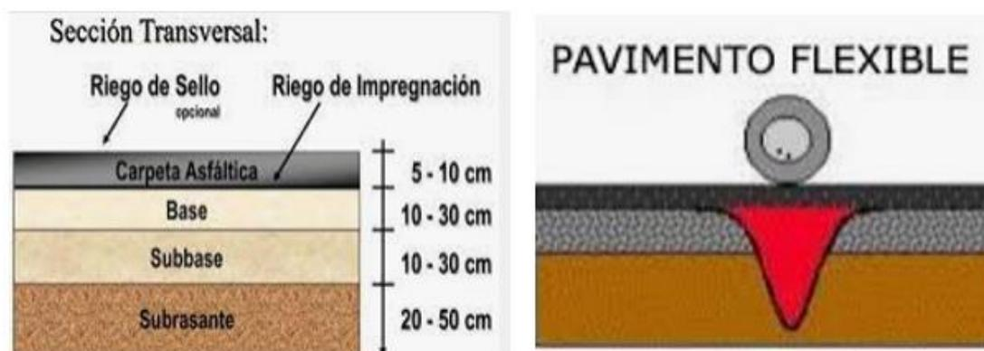
**Figura 13. Pavimentos flexibles con corte transversal.**
