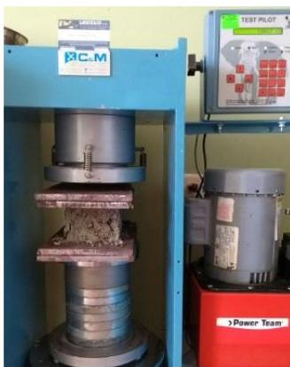
**Figura 33.** Adoquín ensayado con una aplicación de carga uniforme.
