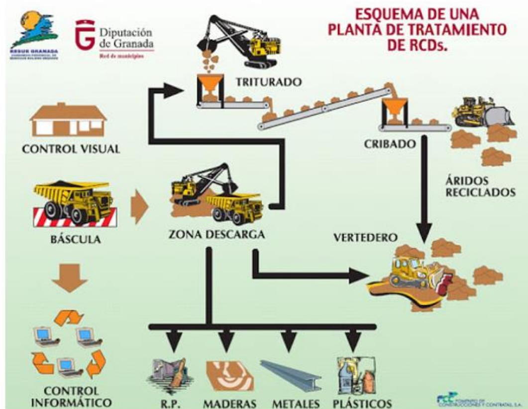
**Figura 3** Esquema de planta de tratamiento de residuos de construcción y demontes.
