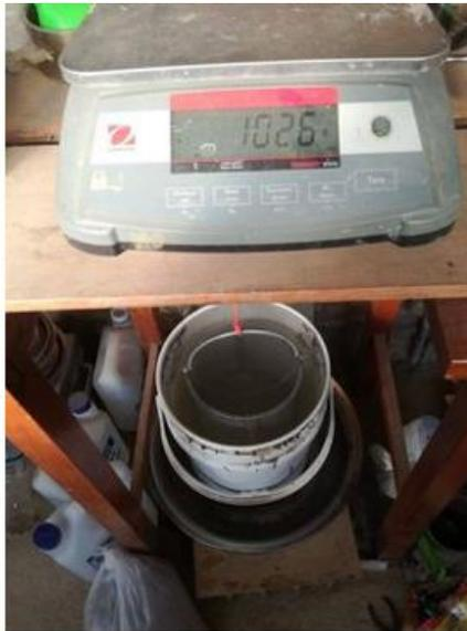
**Figura 28.** Agregado grueso (confitillo) saturado.
