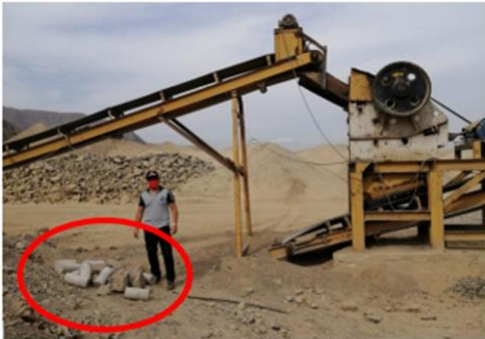
*Figura 26. Agregado reciclado que se pondrá en la chancadora.*
