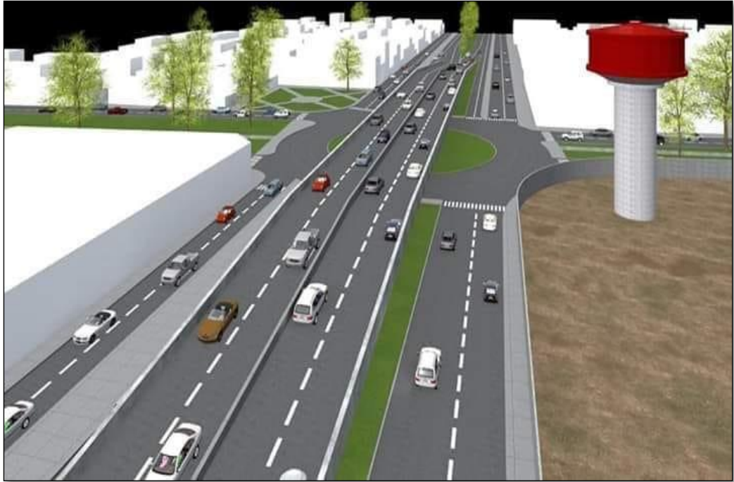
Figura 94: Paso a Desnivel en 3D
