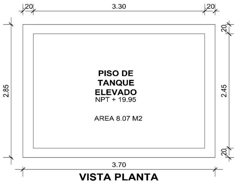
**Figura 91.** Vista en planta del tanque elevado
