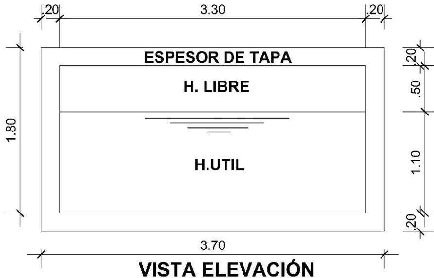
**Figura 90.** Vista en elevación del tanque elevado
