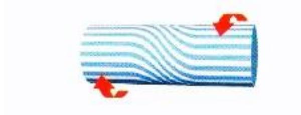
**Figura 55.** Esfuerzo de torsión
