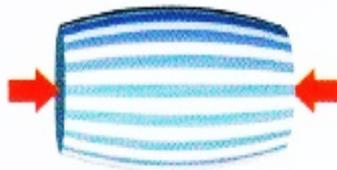
**Figura 53.** Esfuerzo de compresión o axial
