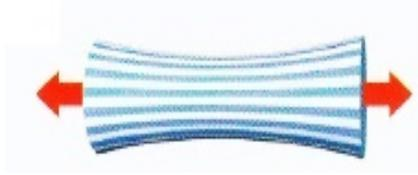
**Figura 52.** Esfuerzo de tracción
