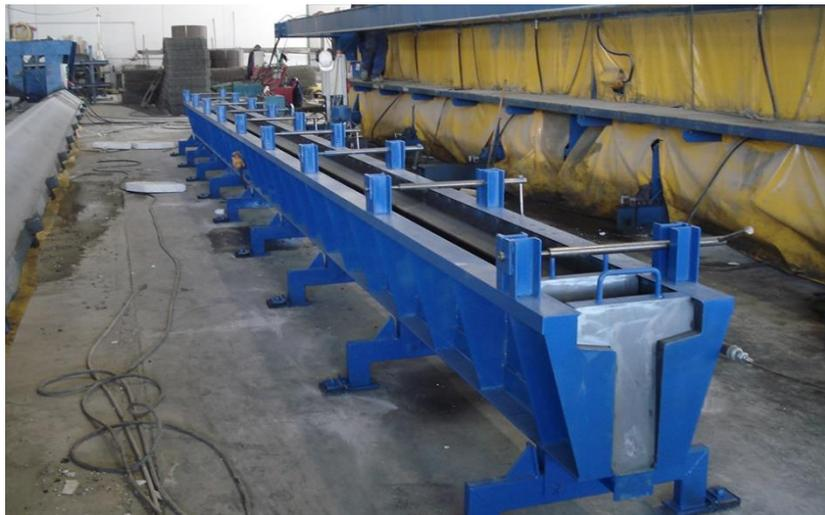
**Figura 12.** Molde para vigas estructurales prefabricadas en T invertida
