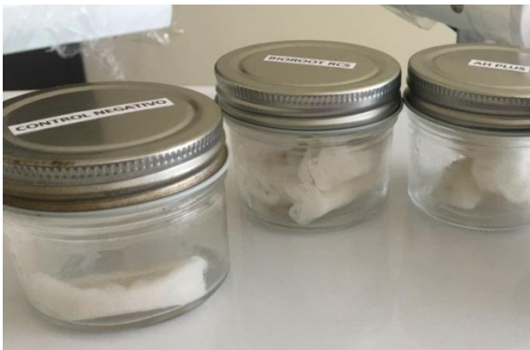
Figura 13. Separación de muestras en envases de vidrio envueltas en gasas húmedas
