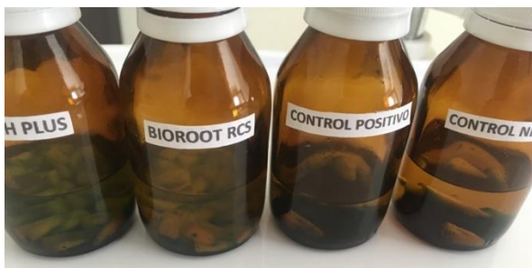
Figura 24. Dientes sumergidos en ácido nítrico al 6% por 72 horas
