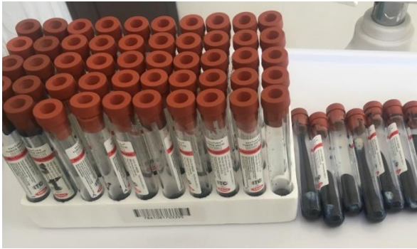
Figura 17. Piezas sumergidas en azul de metileno colocadas en tubos de ensayos
