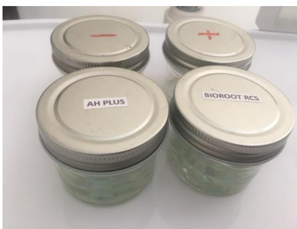
Figura 25. Muestras sumergidas en alcohol al 70% 80% y 96% para su deshidratación
