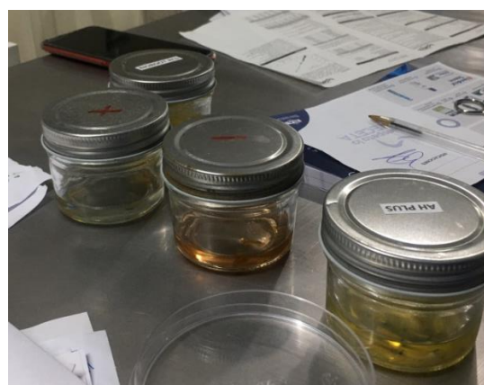
Figura 27. Muestras sumergidas en salicilato de metilo por 5 horas
