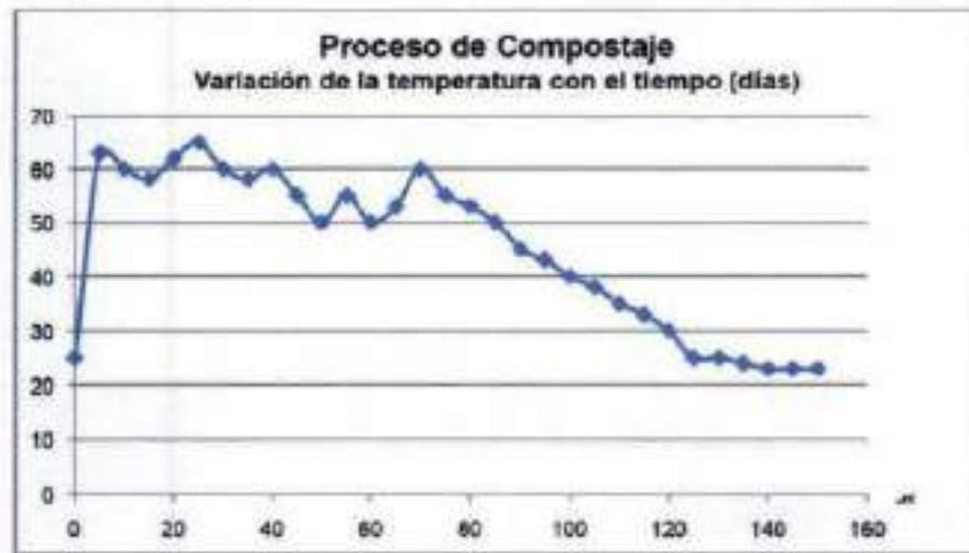
**Figura 22:** Evolución de la Temperatura en una Pila de Compost
